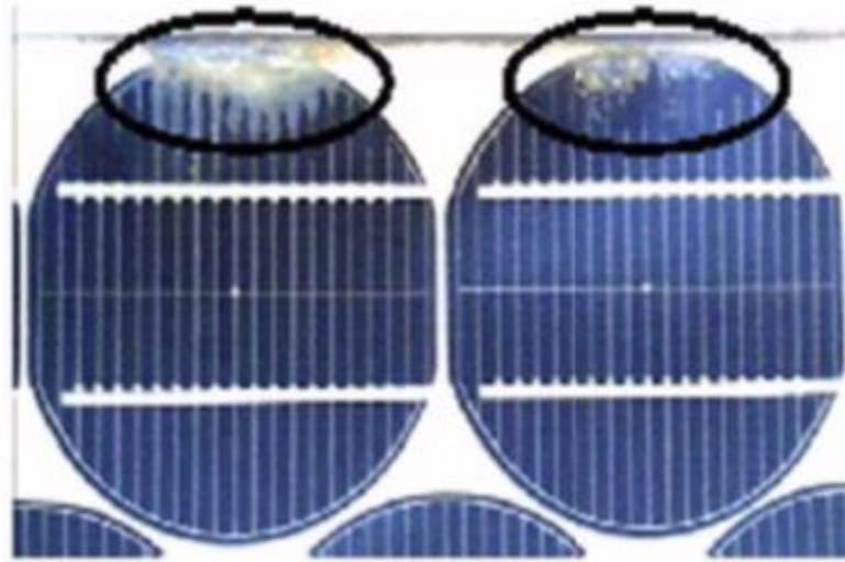
Σχήμα 4.11 : Αποκόλληση τμήματος υλικού επικάλυψης [7]
