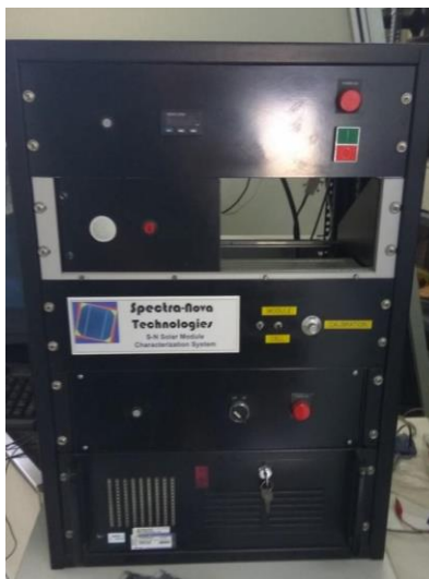
Σχήμα 7.2: Συσκευή παραγωγής μετρήσεων ρεύματος - τάσης
