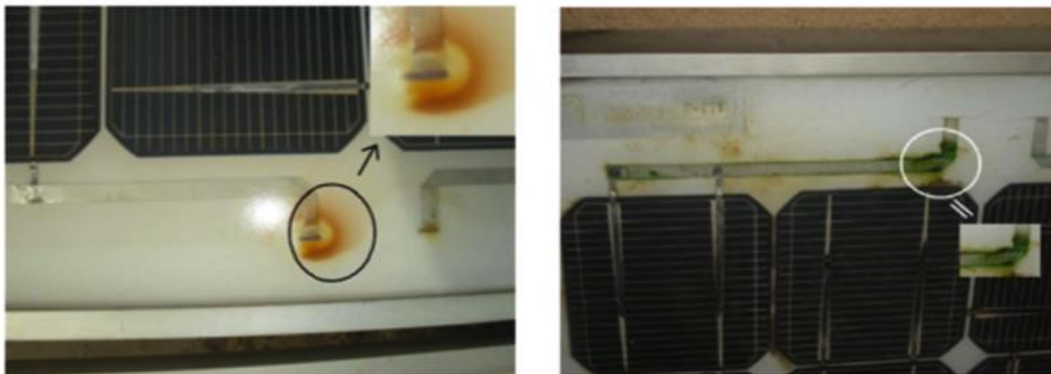
Σχήμα 4.9: Χαρακτηριστική εικόνα διάβρωσης [7]
