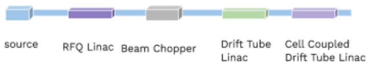
Εικόνα 1.6: Χαρακτηριστική γραμμική επιταχυντική διάταξη που βασίζεται σε ένα μέρος του γραμμικού επιταχυντή LINAC4 στο CERN. Η πηγή ιόντων και κάθε επιταχυντικό γραμμικό στοιχείο συνοδεύονται από μια σειρά στοιχείων εστίασης που συμπεριλαμβάνουν σωληνοειδείς μαγνήτες εστίασης, ηλεκτρομαγνητικά ή μόνιμα τετράπολα. [12],[13]
