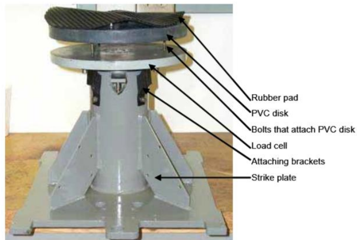
Εικόνα 2.16: Σύνδεση πλάκας κρούσης με δυναμοκυψέλη και κυκλικό δίσκο Πηγή: (Belt, et al., 2006)
