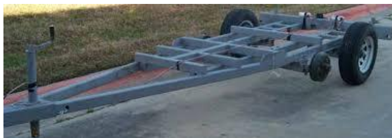
Εικόνα 2.9: Πλαίσιο ρυμούλκησης FWD Πηγή: (Belt, et al., 2006)
