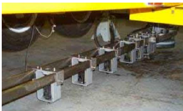
Εικόνα 2.20: Διάταξη γεώφωνων (geophones) Πηγή: (Belt, et al., 2006)
