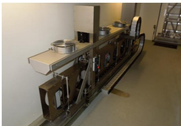
Εικόνα 3.2: Δύσκαμπτη δοκός TSD Πηγή: (Březina, et al., 2017)
