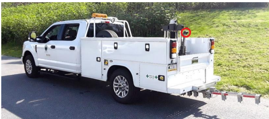
Εικόνα 2.22: Εξωτερική κάμερα σε FWD ενσωματωμένο σε όχημα Πηγή: (Pennsylvania Department of Transportation, 2020)
