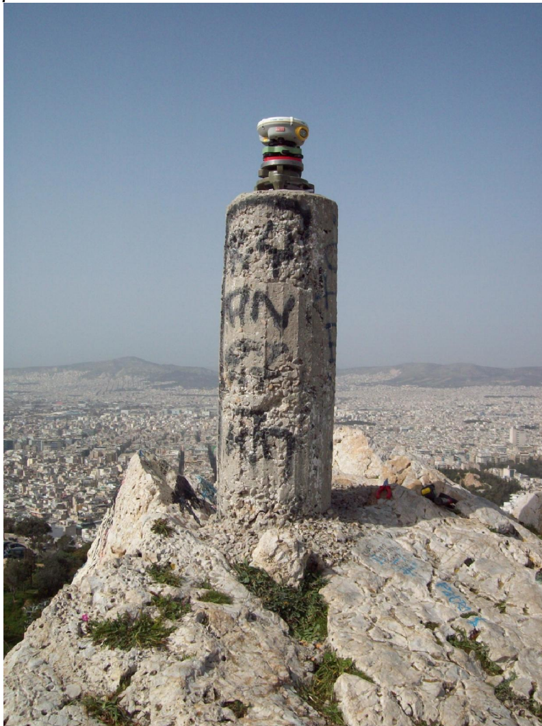
Φωτογραφία 3.5: Ο δορυφορικός δέκτης Trimble 5800 με την βάση εξαναγκασμένης κέντρωσης στο βάθρο Λυκαβηττού.
