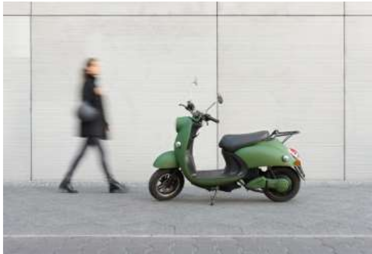
Εικόνα 2.7: ηλεκτρικό πατίνι τύπου Moped. Τα μηχανικά και κινητικά του χαρακτηριστικά είναι περισσότερο κοντά σε μία μοτοσυκλέτα από ό,τι σε ένα ηλεκτρικό πατίνι.
