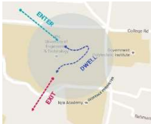
Εικόνα 2.4: επεξηγηματική του πότε «ενεργοποιείται» και πότε «απενεργοποιείται» το γεγονός μίας εικονικής φραγής
