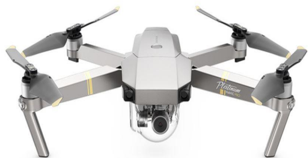
Εικόνα 4.2: DJI Mavic Pro , μπορεί να χρησιμοποιηθεί από επαγγελματίες για λήψη φωτογραφιών και βίντεο, για επιτήρηση τεχνικών έργων, καθώς και για τρισδιάστατη αποτύπωση εδάφους και κτιρίων
