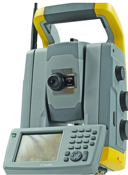
Εικόνα 2.7: Ρομποτικός γεωδαιτικός σταθμός Trimble s6 [13]
