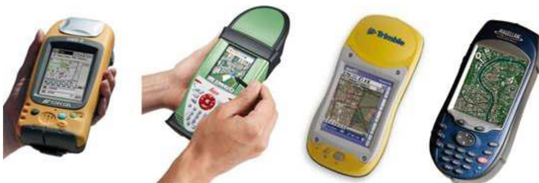
Εικόνα 5.4: Παράδειγμα δεκτών GPS με δυνατότητα διεξαγωγής DGPS που είναι ειδικά σχεδιασμένοι για εφαρμογές GIS [51]
