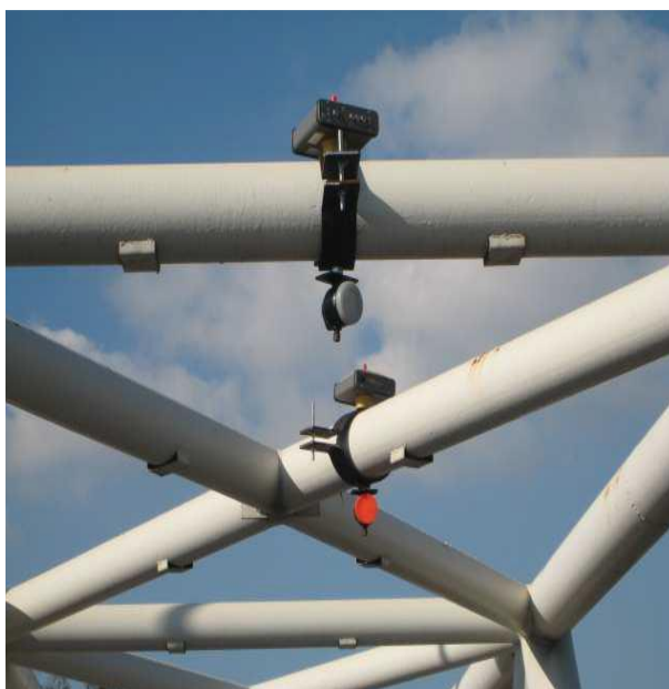
Εικόνα 5.8: Η διάταξη των δεκτών GPS και των ανακλαστήρων πάνω στις τεγίδες και τους οριζόντιους συνδέσμους δυσκαμψίας
