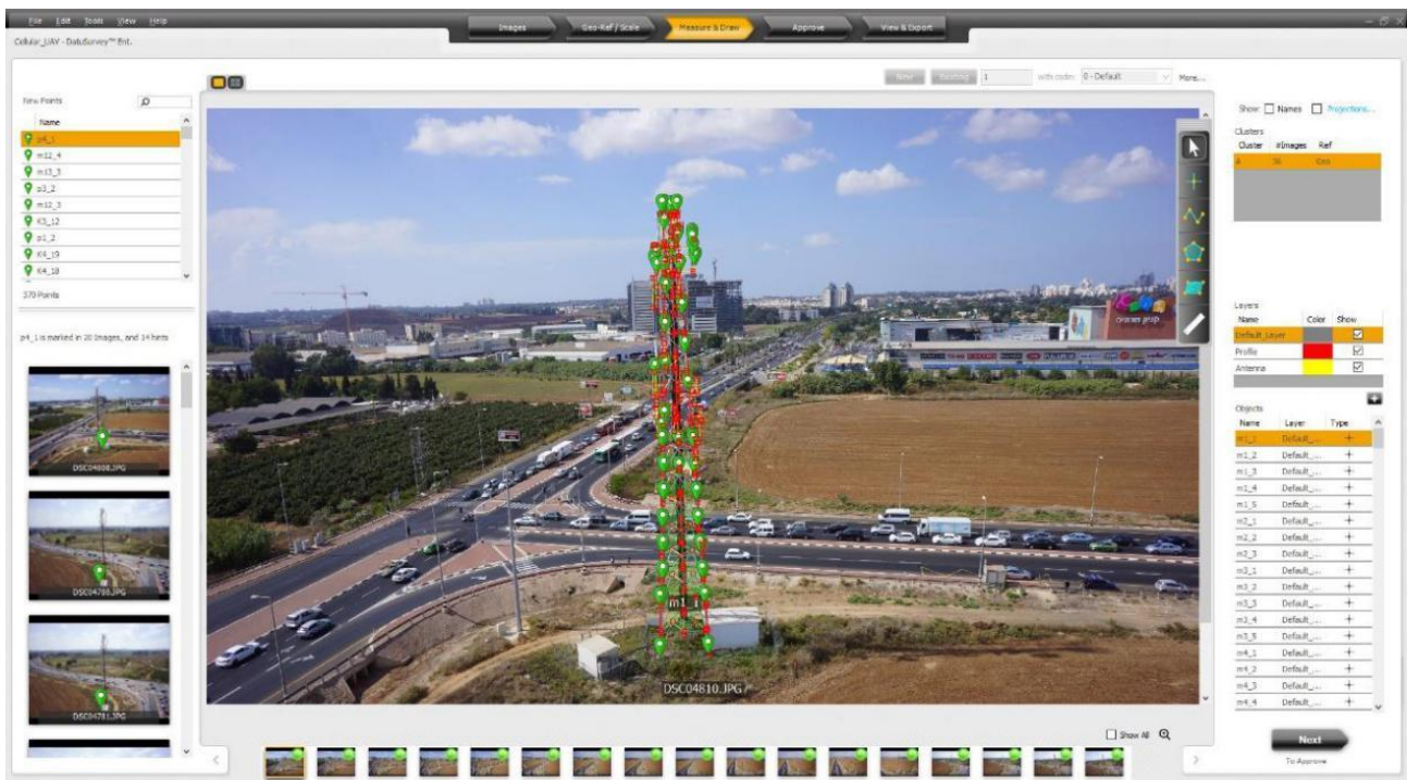
Εικόνα 4.10: Ψηφιακή επεξεργασία των εικόνων για τη σύνθεση του 3D μοντέλου
