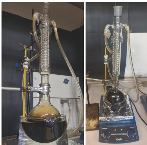
Εικόνα 8: Διάταξη οξείδωσης νανοσωλήνων άνθρακα με μείγμα θειικού και νιτρικού οξέος
