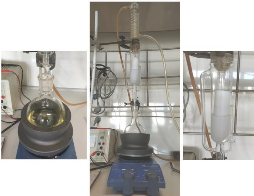
Εικόνα 7: Διάταξη εκχύλισης Soxlet
