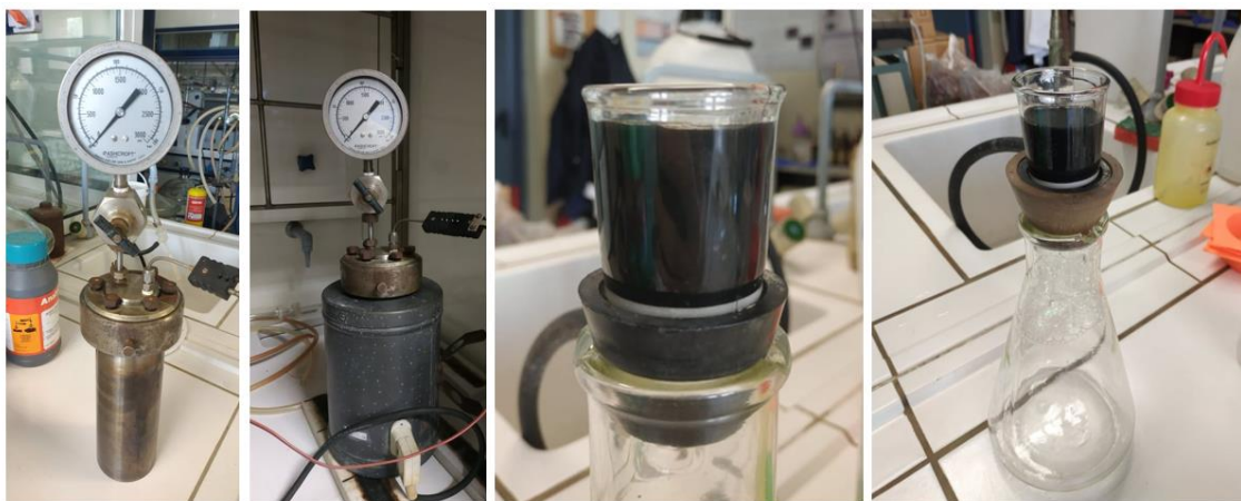
Εικόνα 9: Από αριστερά προς τα δεξιά: Αυτόκλειστο χωρητικότητας 120ml, Αυτόκλειστο με μανδύα θέρμανσης, Ηθμός GOOCH με CNTs και GO σε διάλυμα PSS 1%, Διήθηση υπό κενό
