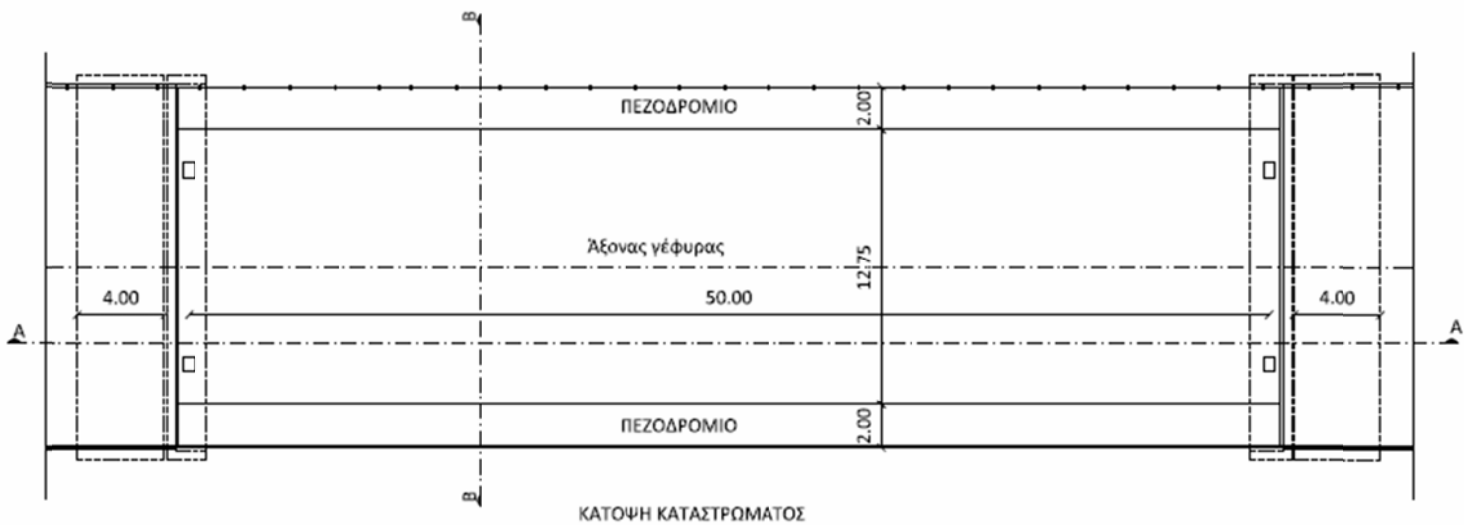
Σχήμα 5.1: Κάτοψη της γέφυρας
