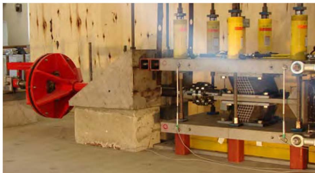
Εικόνα 3.4: Πειραματική διάταξη απόκρισης ελαστομεταλλικών εφεδράνων
