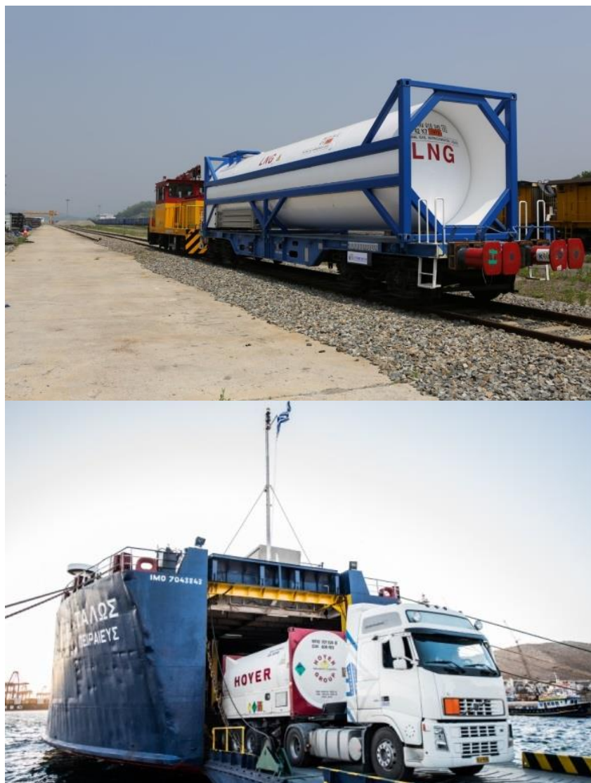
Εικόνα 5: Τρόποι μεταφοράς LNG – μέσω τρένων και φορτηγών [149]
