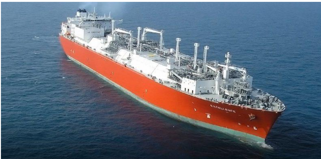
Εικόνα 9: Πλοίο μεταφοράς με μονάδα επαναεριοποίησης επί του καταστρώματος [154]
