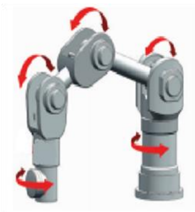
Σχήμα 7.3: Οι πέντε βαθμοί ελευθερίας του ρομποτικού βραχίονα Katana 6M180
