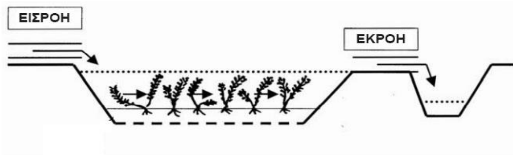
Σχήμα 2.14: Σχηματική αναπαράσταση τεχνητού υγροβιότοπου βυθισμένων φυτών (Vymazal & Kropefelova, 2008)
