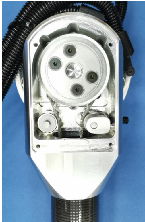
Σχήμα 5-12. Το εσωτερικό τμήμα του άνω άκρου του ισχίου.
