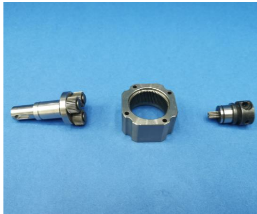
Σχήμα 4-2. Πλήρης αποσυναρμολόγηση των πλανητικών μειωτήρων.
