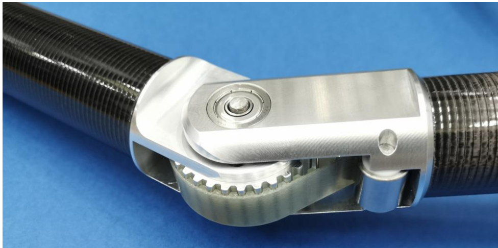
Σχήμα 5-11. Οδήγηση του ιμάντα εντός του σωλήνα ανθρακονήματος.
