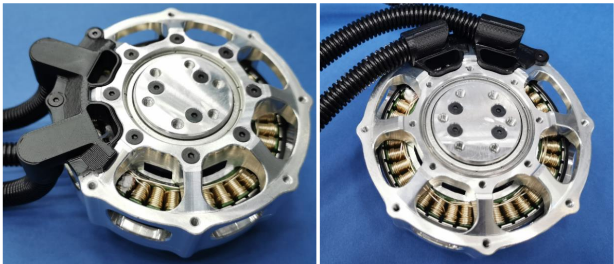
Σχήμα 5-8. Οργάνωση και προστασία των καλωδίων με την χρήση σπιράλ και κατάλληλων πλαστικών άκρων.
