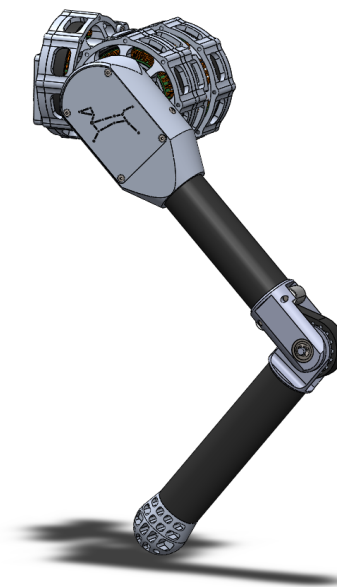
Σχήμα 4-16. Ενσωμάτωση του ποδιού στο συναρμολόγημα των τριών μονάδων επενέργησης.
