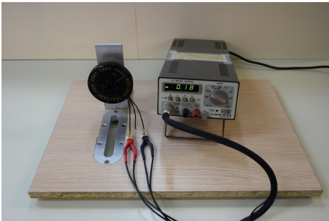
Σχήμα 3-10. Μέτρηση της αντίστασης του T Motor U8 Lite με την χρήση του RLC Meter.
