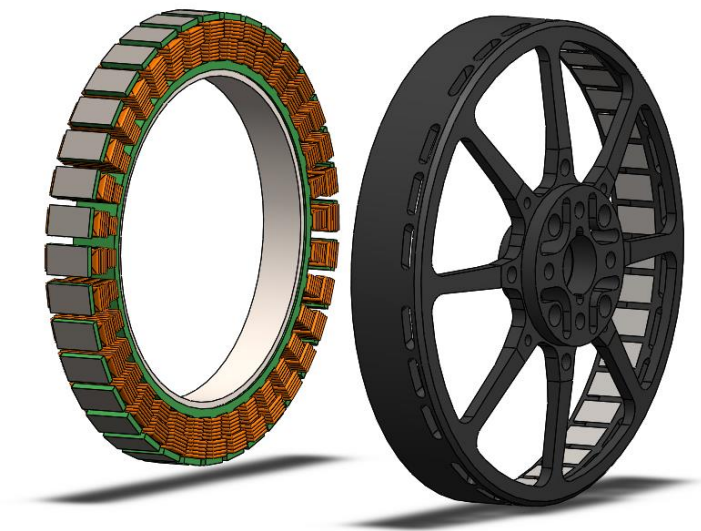
Σχήμα 4-5. Αποδόμηση του ρότορα και του στάτη.
