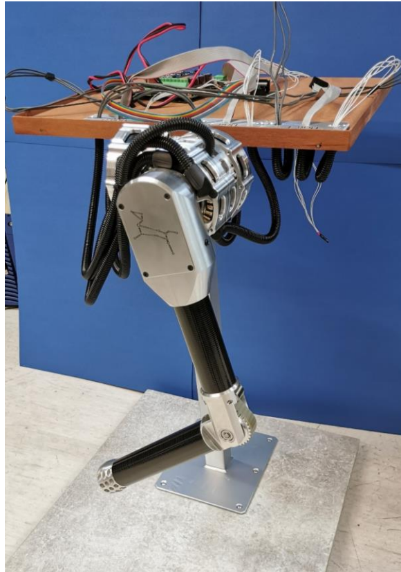
Σχήμα 5-14. Το συναρμολογημένο πόδι τριών βαθμών ελευθερίας πάνω στην ειδική βάση.
