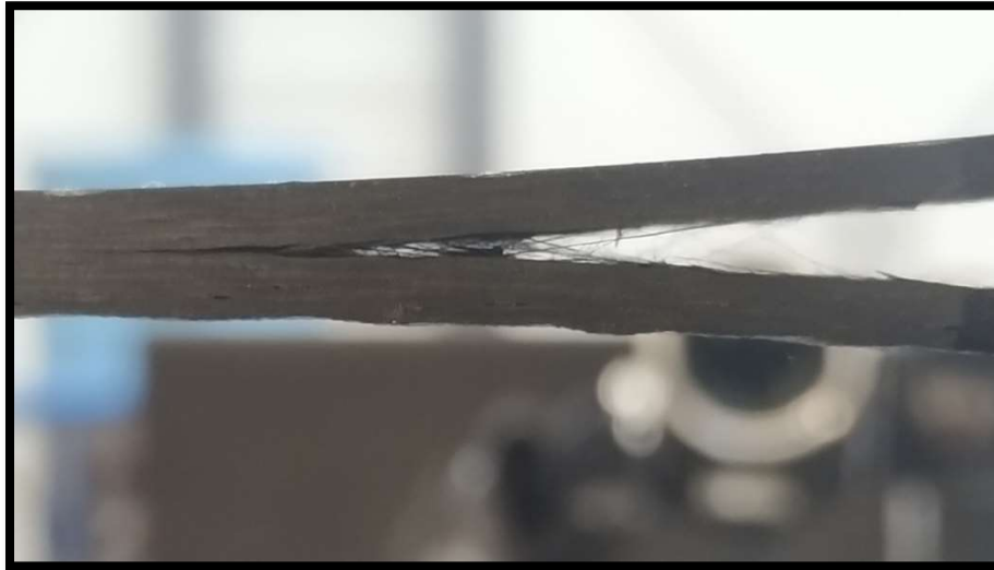
Σχήμα 7.9 Χαρακτηριστική αποκόλληση των ινών άνθρακα στην δοκιμή fracture toughness.
