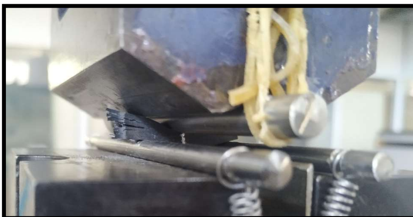
Σχήμα 7.15 Απεικόνιση της δοκιμής διάτμησης που χρησιμοποιήθηκε.[15]
