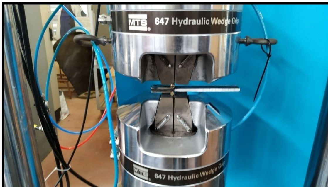
Σχήμα 7.8 Δοκιμή μελέτης διάδοσης της ρωγμής στο σύνθετο δοκίμιο (fracture toughness test)
