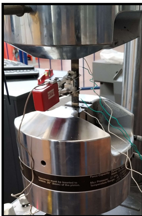
Σχήμα 7.4 Διάταξη δοκιμής σε εφελκυσμό.
