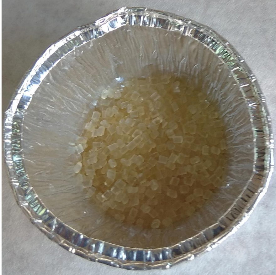
Σχήμα 3.5 : Το στερεοσύμπλοκο PLA (Biofront® grade J20) που χρησιμοποιήθηκε ως βάση των βιτριμερών scPLA-γλυκερίνης
