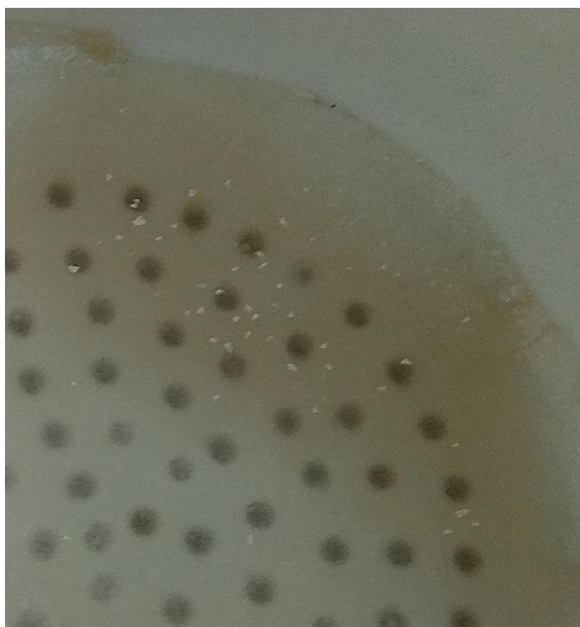
Σχήμα 5.4: Λήψη των αδιάλυτων στερεών κατά την διήθηση του δείγματος 6.4% 150°C,24h->180°C,3h
