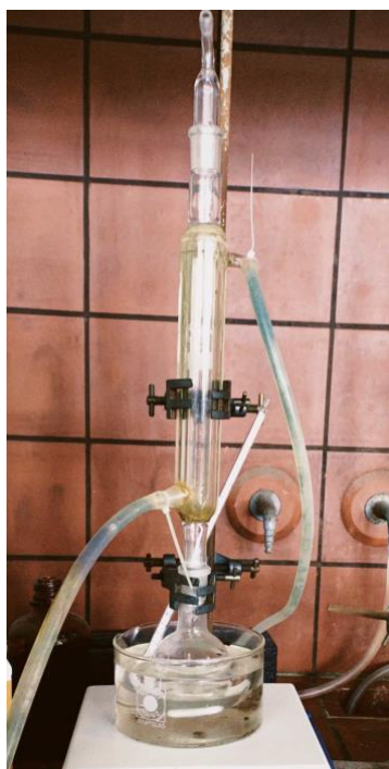
Εικόνα 2-1: Πειραματική διάταξη παρασκευής NaDES με ελεγχόμενη θέρμανση και μαγνητική ανάδευση.
