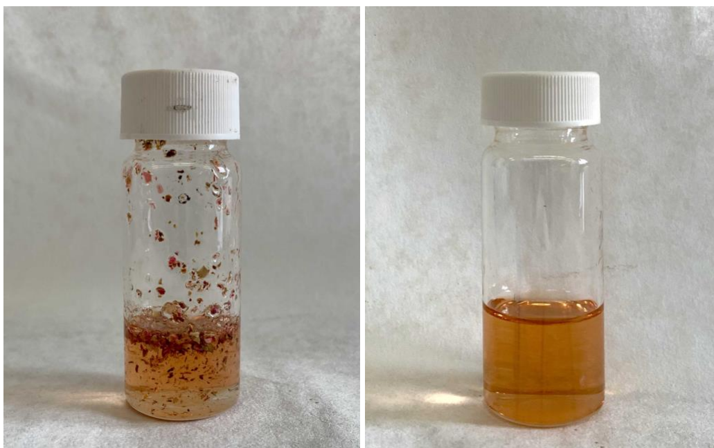
Εικόνα 2-3: (i) Εκχύλισμα E/ChCl:CA πριν τη διήθηση, αριστερά (ii) Εκχύλισμα E/ChCl:CA μετά τη διήθηση, δεξιά.
