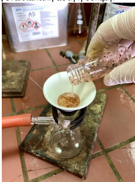
Εικόνα 2-2: Διήθηση του εκχυλίσματος E/ChCl:CA, προς απομάκρυνση της στερεής πρώτης ύλης και παραλαβής του τελικού εκχυλίσματος.
