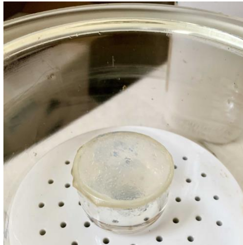
Εικόνα 2-7: Το σύστημα κρυσταλλωτήριο – νερό – φιλμ παραμένει εντός ξηραντήρα ανάμεσα στη λήψη των διαδοχικών του ζυγίσεων.
