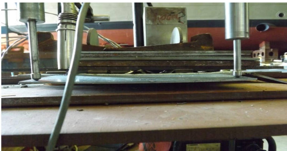
Εικ.5.7: Τοποθέτηση LVDT στο έλασμα (1 η δοκιμή)
