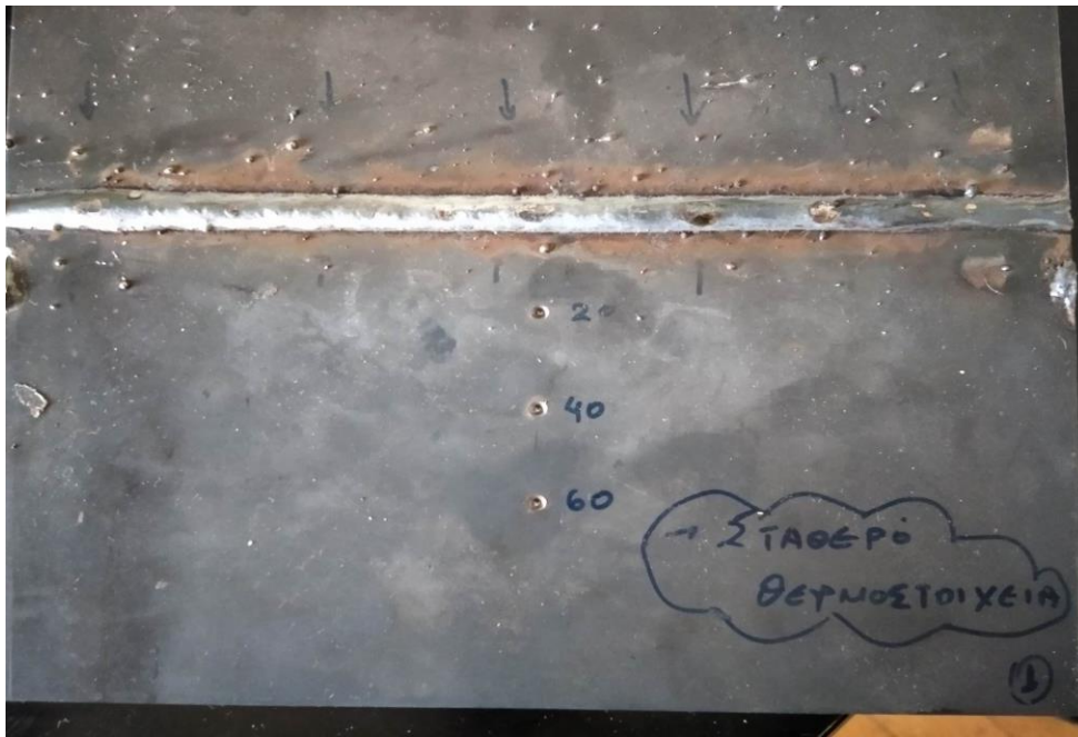
Εικ.5.6 Οπές τοποθέτησης των θερμοστοιχείων
