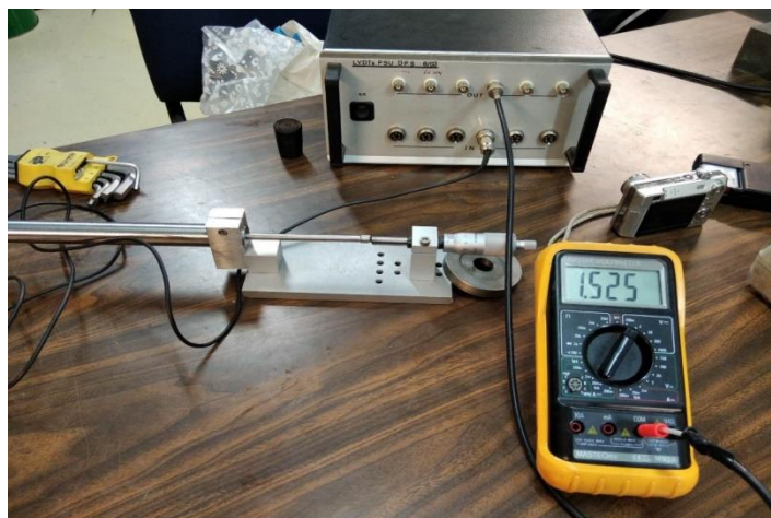
Εικ: 5.8 Διάταξη Μικρόμετρο-LVDT-Ενισχυτής σήματος-Πολύμετρο
