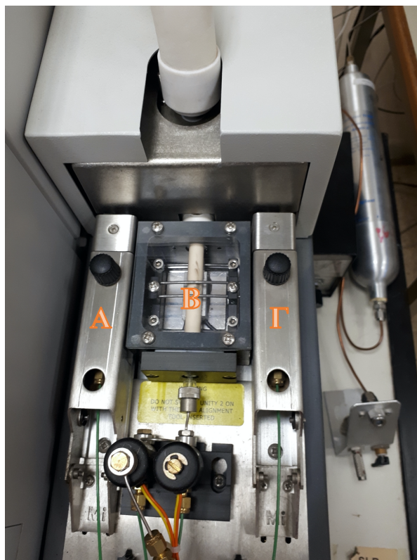
Εικόνα 26: Κάτωψη του TDU που χρησιμοποιήθηκε: (Α) Φούρνος, (Β) Κρυοπαγίδα, (Γ) Θύρα κατακράτησης ΠΟΕ
