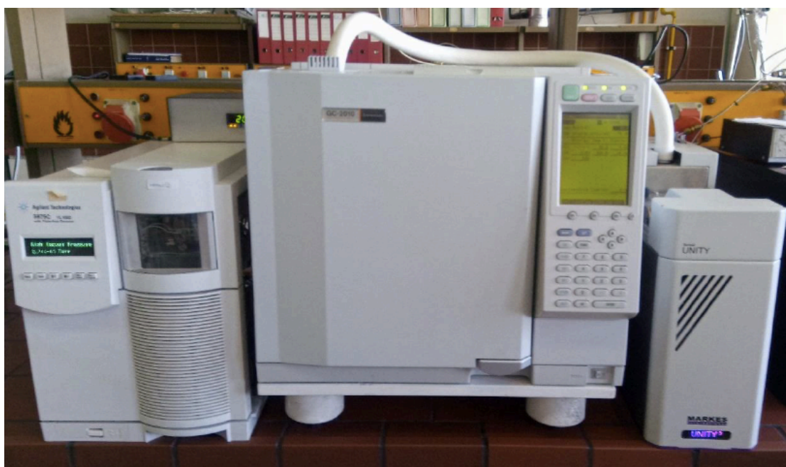
Εικόνα 25: Το σύστημα TDU-GC-MS που χρησιμοποιήθηκε για τις αναλύσεις στη Σχολή Χημικών Μηχανικών του ΕΜΠ
