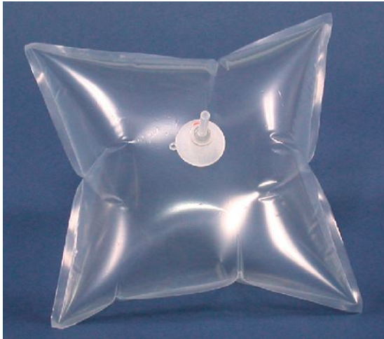
Εικόνα 5: Σακούλα πολυμερούς για δειγματοληψία αέρα
