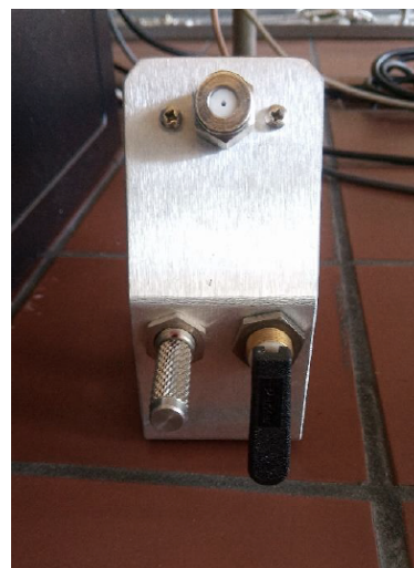
Εικόνα 22: Σύστημα εισαγωγής του εσωτερικού προτύπου στους προσροφητικούς σωλήνες της μελέτης
