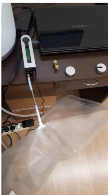
Εικόνα 24: Συνδεσμολογία μεταφοράς του δείγματος εκπνεόμενου αέρα από την Tedlar® στον προσροφητικό σωλήνα
