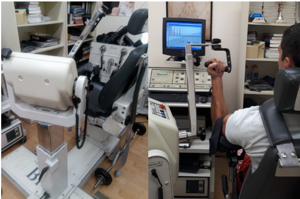
Εικόνα 21: Όργανο ισομετρικής μυϊκής συστολής BIODEX System 3 PRO (αριστερά), Εφαρμογή πρωτοκόλλου άσκησης σε εθελοντή (δεξιά)
