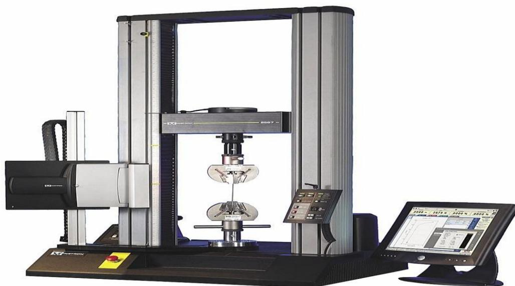
Σχήμα :Μηχανή Instron εργαστηρίου
