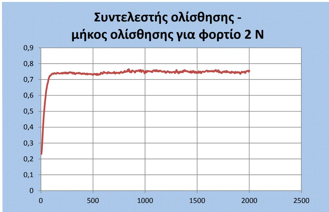
Σχήμα: Συντελεστών τριβής για κάθετο 2 N φορτίο με ανταγωνιστικό υλικό του σφαιριδίου  $Al_2O_3$ .
