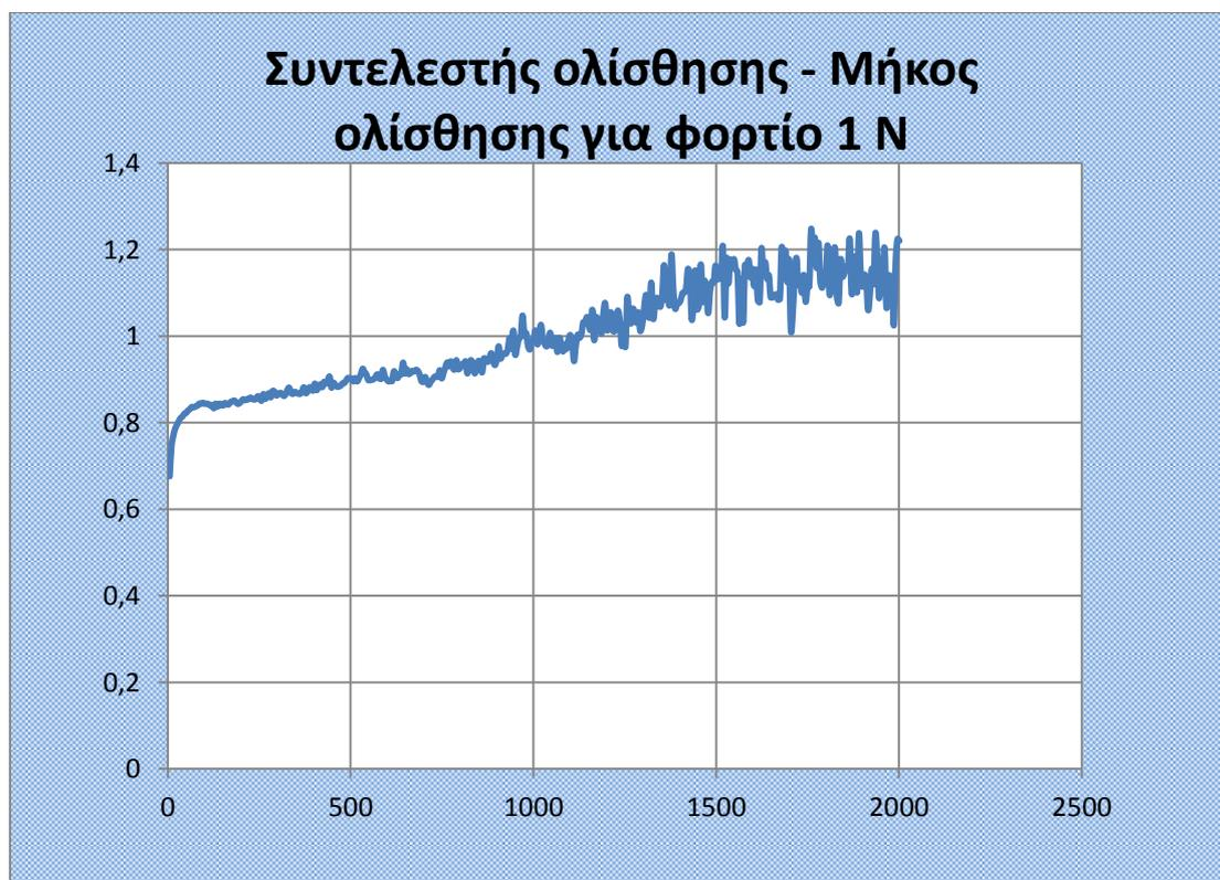
Σχήμα: Συντελεστών τριβής για κάθετο 1 N φορτίο με ανταγωνιστικό υλικό του σφαιριδίου Al<sub>2</sub>O<sub>3</sub>.
