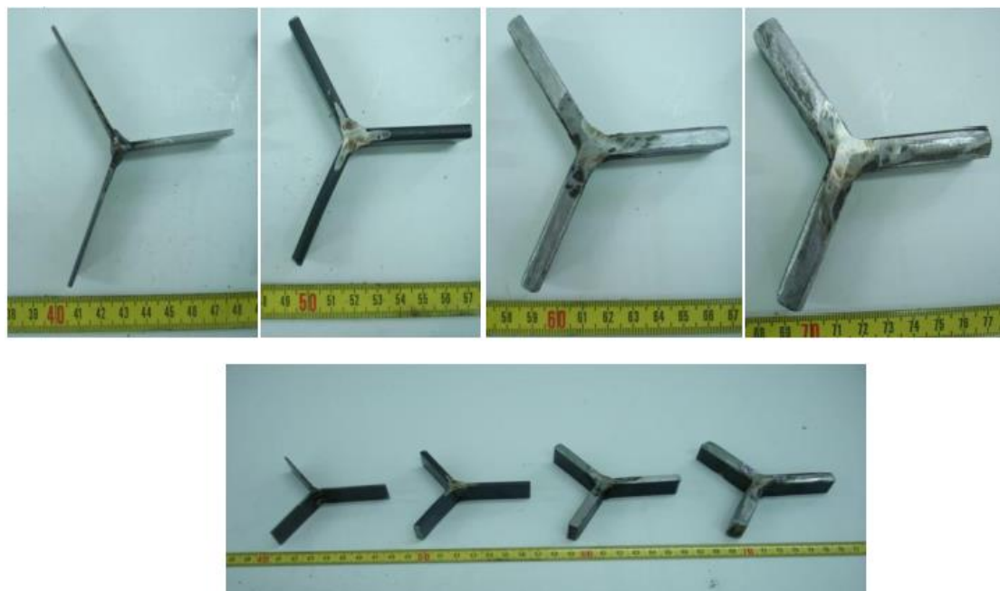
Εικόνα 22 Μηχανισμοί triggering S1, S2, S3, S4 (από αριστερά προς τα δεξιά)
