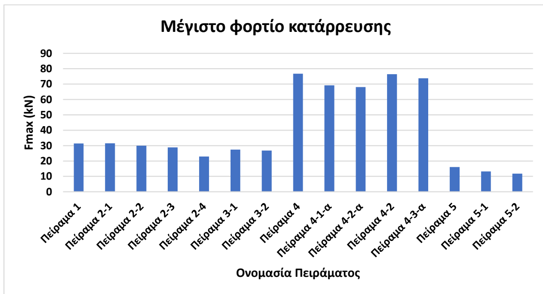
Εικόνα 56 Μέγιστο φορτίο κατάρρευσης- Πειραματικά αποτελέσματα
