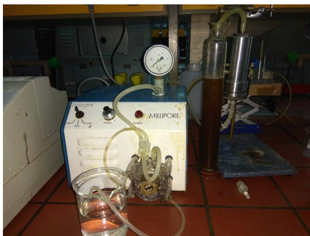
Εικόνα 28. Σύστημα εκχύλισης με ανοξειδωτο εκχυλιστήρα και αντλία Millipore ογκομετρικό κύλινδρο συλλογής εκχυλίσματος (δεξιά) και το ποτήρι ζέσεως με διαλύτη (αριστερά)
