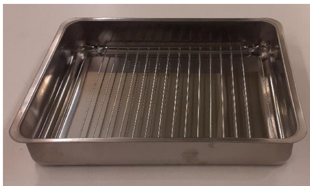
Εικόνα 4.22: Προετοιμασία δοχείου υποδοχής υγρού αζώτου για τη δοκιμή #A2.
