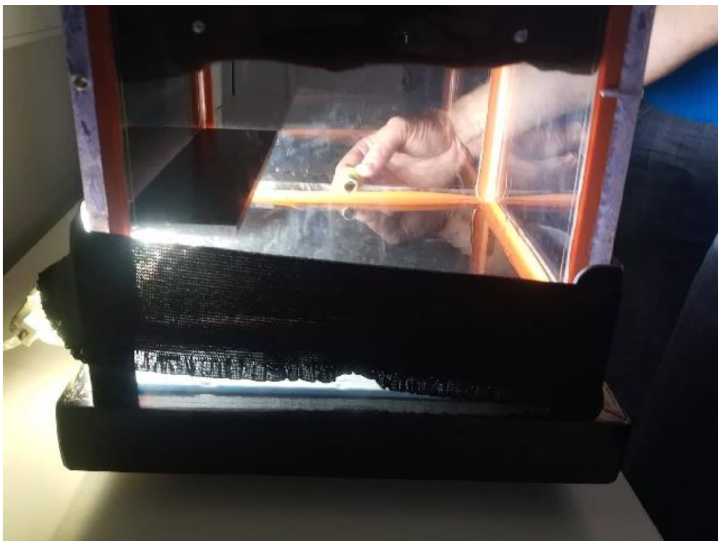
Εικόνα 4.14: Πλάγια όψη θαλάμου νεφώσεως τύπου διαχύσεως CRC-DC της ΕΕΑΕ. Διακρίνεται η σιλικόνη για τη στεγανότητα (πορτοκαλί χρώμα) και μικρή θύρα για την τοποθέτηση πηγών.
