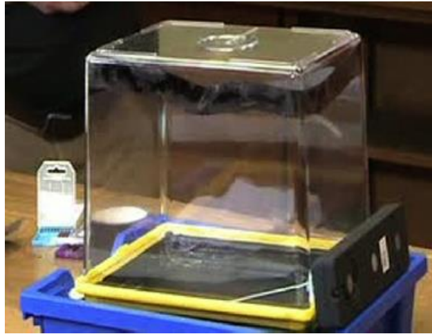
Εικόνα 1.1: Η υλοποίηση καθοδικού θαλάμου διάχυσης από τον Green (2015). Κάτω: δοχείο με ξηρό πάγο. Άνω: στεγανός θάλαμος με βάση το κουτί ενός ενυδρείου.
