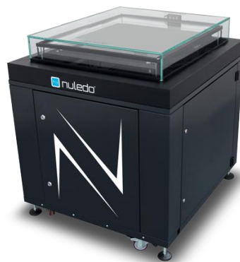
Εικόνα 4.9: Θάλαμος νεφώσεως τύπου διαχύσεως NULEDO COMPACTA της εταιρείας NULEDO s.r.o.
