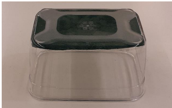
Εικόνα 4.9: Φαγητοδοχείο από ακρυλικό πλαστικό. Στο εσωτερικό της οροφής διακρίνεται ύφασμα - τσόχα.
