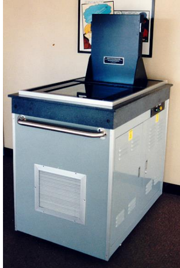
Εικόνα 4.10: Θάλαμος νεφώσεως τύπου διαχύσεως MCC-50 της εταιρείας CloudChambersDotCom.
