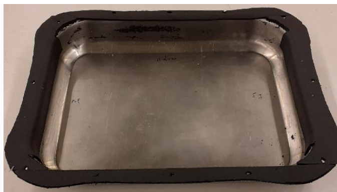
Εικόνα 4.6: Ανοξείδωτο ταγί με πλατιές παρειές ως δοχείο αζώτου για το ψυχόμενο δάπεδο.
