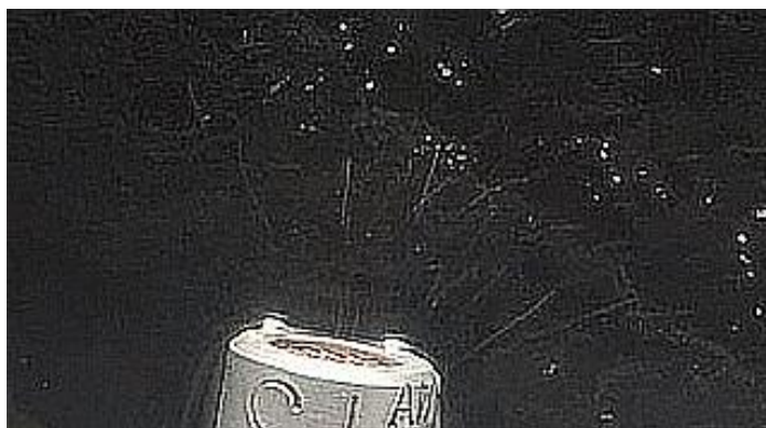
Εικόνα 5.4: Ίχνη ηλεκτρονίων μεγάλης κινητικής ενέργειας από πηγή Sr-90 κατά τη δοκιμή #B1.
