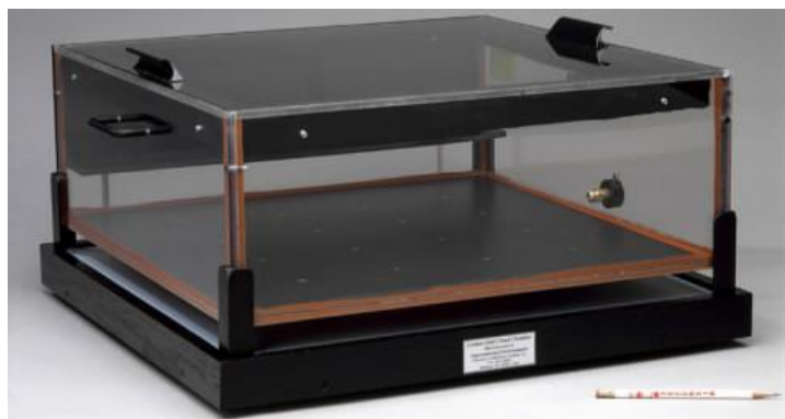
Εικόνα 4.11: Θάλαμος νεφώσεως τύπου διαχύσεως LHC-DC της εταιρείας CloudChambersDotCom.
