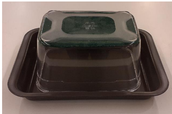
Εικόνα 4.21: Προετοιμασία ψυχόμενης επιφάνειας για τη δοκιμή #A2.
