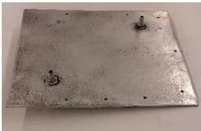
Εικόνα 4.4: Το ψυχόμενο δάπεδο από αλουμίνιο με τα ακροφύσια εισόδου (κάτω αριστερά) και εξόδου (άνω δεξιά) του υγρού αζώτου
