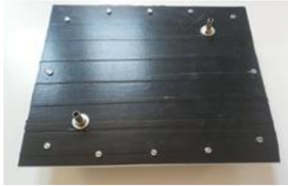
Εικόνα 5.1: Μαύρη επιφάνεια για το ψυχόμενο δάπεδο της δοκιμής #B1
