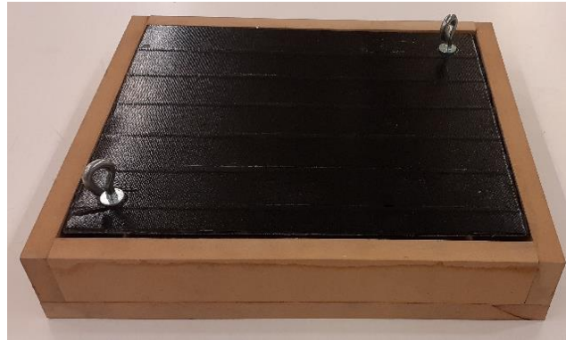
Εικόνα 4.27: Ψυχόμενη μεταλλική επιφάνεια από αλουμίνιο καλυμμένη με μαύρη μονωτική ταινία για τη δοκιμή #A4.
