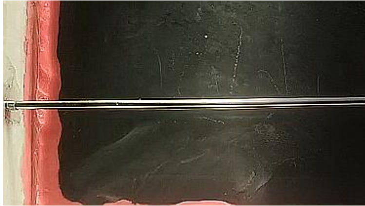
Εικόνα 5.10: Ίχνη -α σωματιδίων από ηλεκτρόδιο που περιέχει Th-232 κατά τη δοκιμή #B3.
