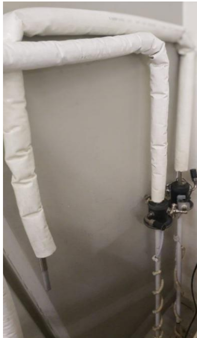
Εικόνα 3.24: Εργαλεία μετάγγισης με ηλεκτρική αντίσταση που χρησιμοποιούνται στο ΕΠΤ-ΕΜΠ. Πρόκειται για τροποποιημένα εργαλεία τύπου PC - 250 της Air-Liquide
