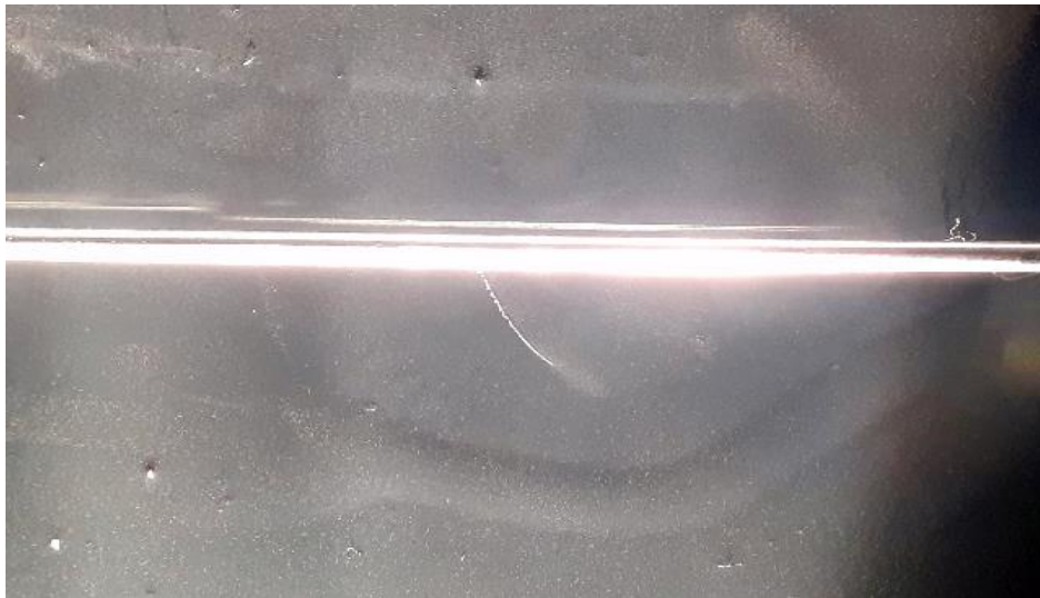
Εικόνα 5.19: Ίχνος -α σωματιδίου (κέντρο). Ίχνος -δ ακτινοβολίας ή ηλεκτρονίου (δεξιά)
