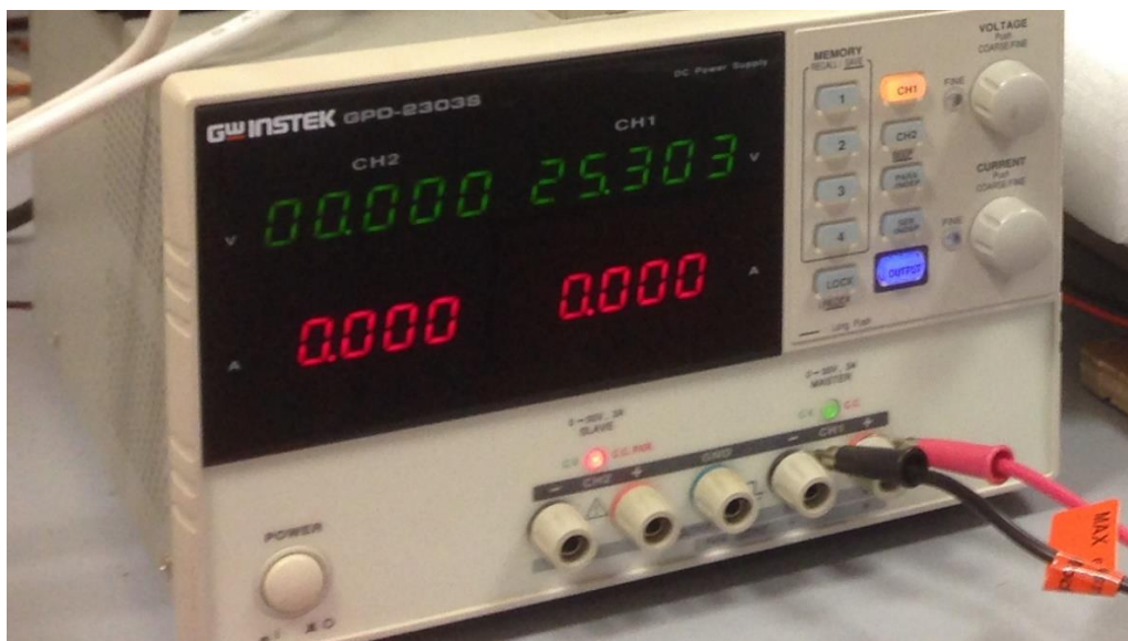
Σχήμα 1.2 Τροφοδοτικό με τάση εξόδου 25 V
