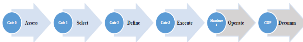
Σχήμα 1-29: Γενικές φάσεις τυπικών υπεράκτιων έργων φυσικού αερίου
