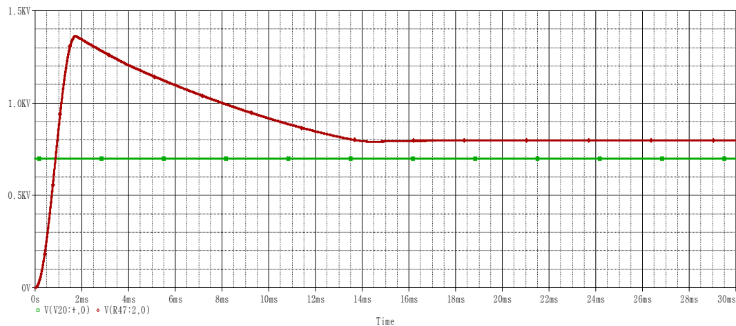
Σχήμα 4.2 Τάση εισόδου και εξόδου του μετατροπέα ανύψωσης τάσης. Dc είσοδος με πράσινο χρώμα, η έξοδος με κόκκινο.
