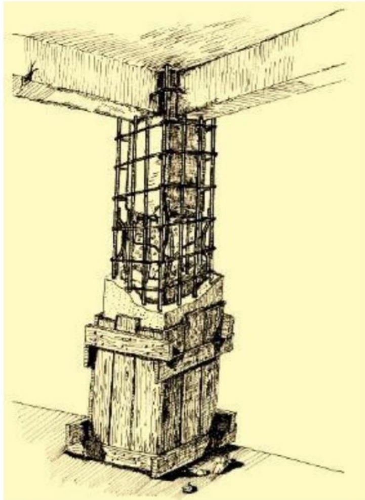
Εικόνα 5.3 Κατασκευή μανδύα από οπλισμένο σκυρόδεμα
