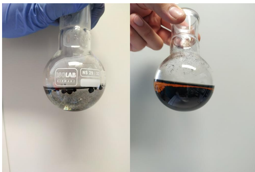
Σχήμα 6.22: α) Μίγμα (DMF, sarcosine, boc) με MWCNTs πριν τη θέρμανση με μικροκυματική ακτινοβολία, β) Μίγμα (DMF, sarcosine, boc) με MWCNT μετά τη θέρμανση με μικροκυματική ακτινοβολία.
