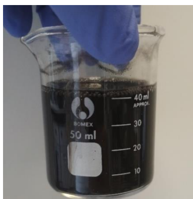
Σχήμα 6.10: Μίγμα o-MWCNTs με PSS 1% w/v μετά από ανάδευση με υπερήχους
