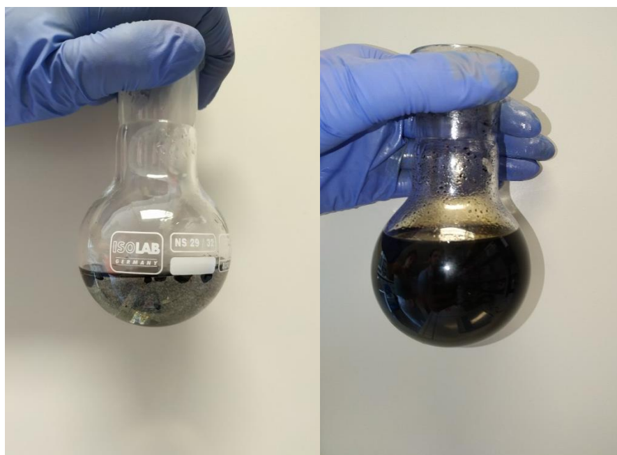
Σχήμα 6.5: α) Εναιώρημα των νανοσωλήνων πριν την οξείδωση σε διάλυμα \text{HNO}_3/\text{H}_2\text{SO}_4 . β) Διαλυτοί νανοσωλήνες μετά την οξείδωση με μικροκυματική ακτινοβολία.
