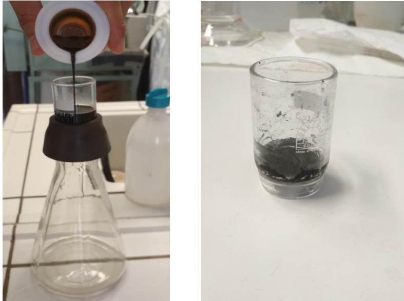
Σχήμα 6.14: α) Διήθηση υπό κενό για την παραλαβή των συντιθέμενων Mg(OH)_2 -MWCNTs, β) Δείγμα Mg(OH)_2 -MWCNTs έπειτα από ξήρανση στους 60 °C για περίπου 12 h.
