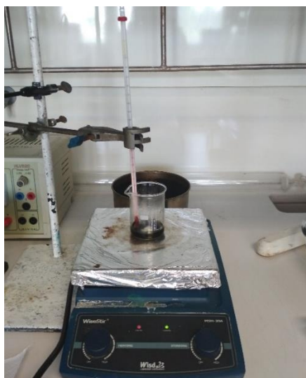
Σχήμα 6.24: Διάταξη με πλάκα θέρμανσης και μαγνητική ανάδευση των amino-f-MWCNTs για την αποπροστασία της boc ομάδας.
