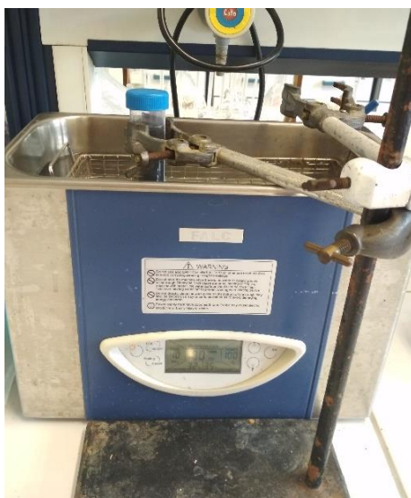
Σχήμα 6.9: Συσκευή ανάδευσης με υπερήχους του δείγματος της εταιρείας Falc (Σχολή Χημ.Μηχ).
