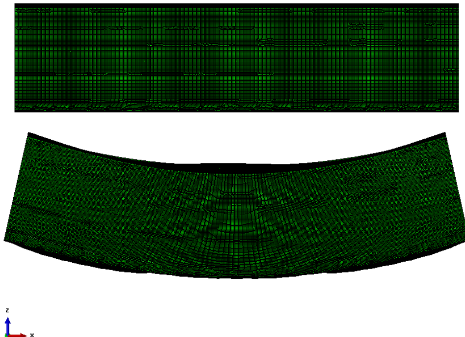
Εικόνα 31 : Απαραμόρφωτη (επάνω) και παραμορφωμένη (κάτω) όψη του προσομοιώματος τριών διαμερισμάτων.
