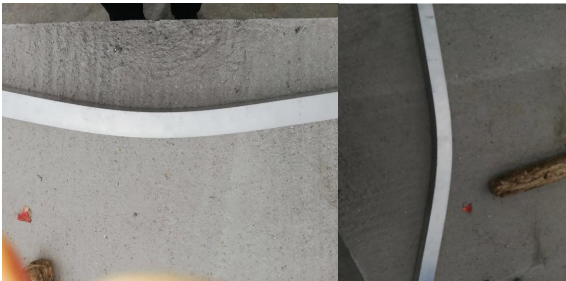
Εικόνα 1.16: Αστοχία αλουμινένιων κοιλοδοκών γνωστής ελληνικής εταιρείας κατασκευής ιστών κινητής τηλεφωνίας
