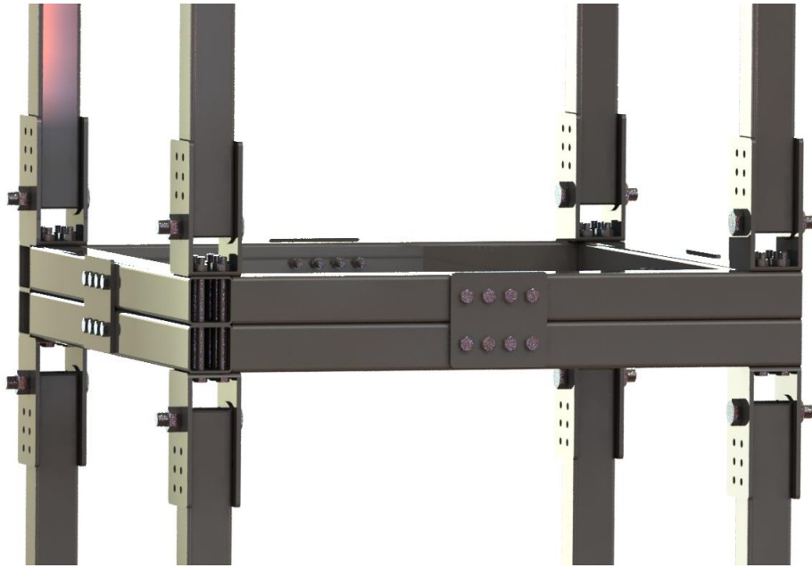
Εικόνα 4.16: Αρθρώσεις ελεύθερες να περιστραφούν περί τον άξονα των κοχλιών Φ30
