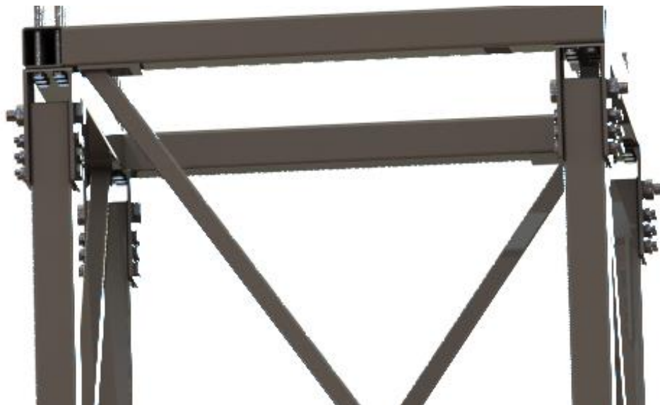
Εικόνα 4.20: Οι διαδοκίδες τοποθετημένες.
