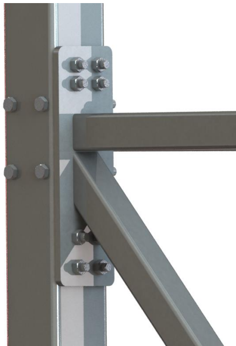
Εικόνα 3.60: Λεπτομέρεια δυνδεσμολογίας διαδοκίδων
