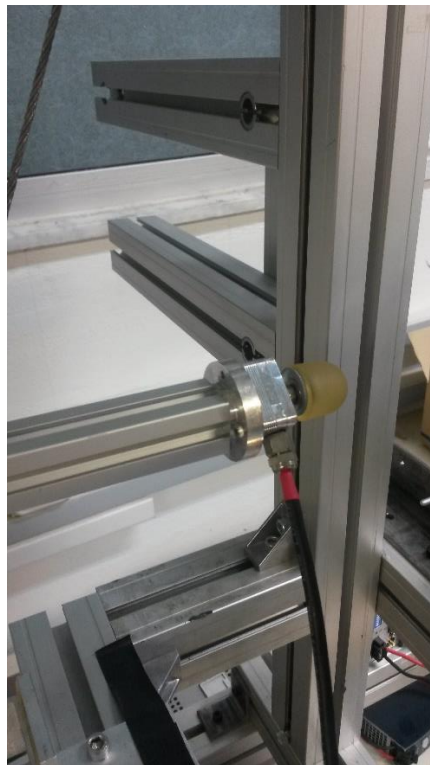
Σχήμα 4-14. Σύνδεση βραχίονα, αισθητήρα δύναμης και επικρουστήρα.
