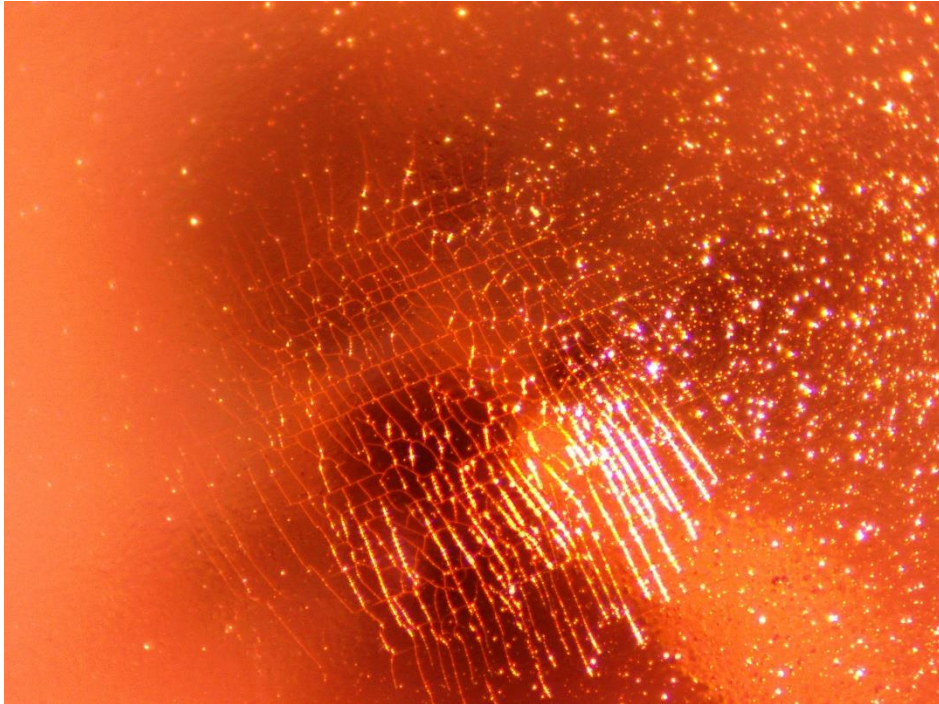
Σχήμα 3.46: Επιφάνεια Karton/Co (150 nm) με εξωτερική επιβολή τάσης (2,3% παραμόρφωση).
