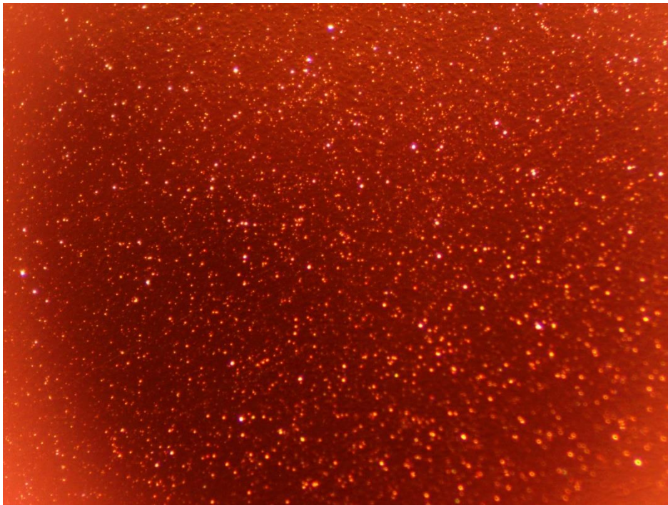
Σχήμα 3.44: Επιφάνεια Krypton/Co (150 nm) με εξωτερική επιβολή τάσης (1% παραμόρφωση).
