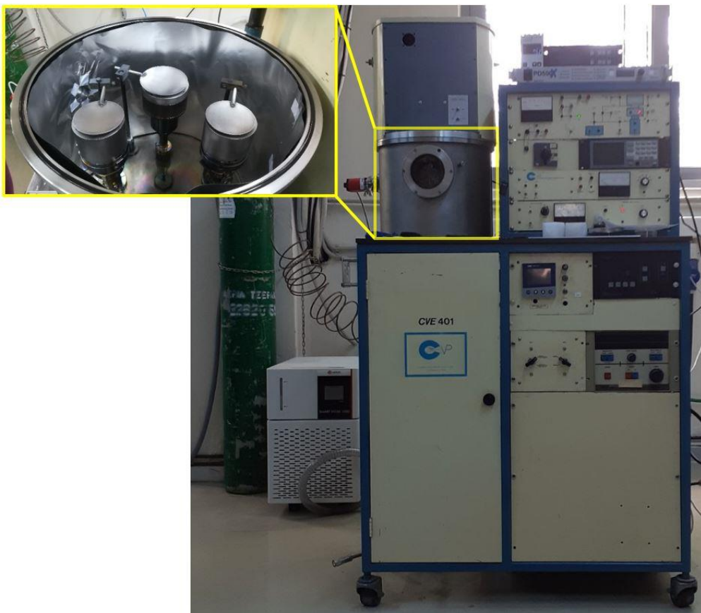
Σχήμα 3.1: Η διάταξη sputtering και το εσωτερικό του θαλάμου κενού.
