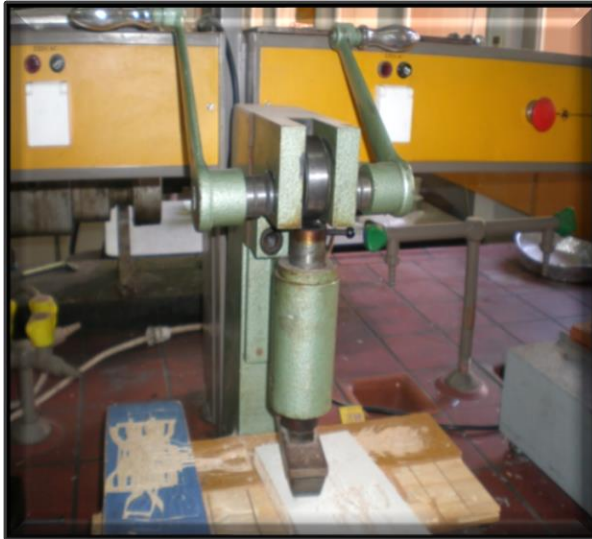
Εικόνα 4.17. Μηχάνημα κοπής δοκιμίων (αριστερά), διάταξη δοκιμής σε εφελκυσμό (δεξιά).
