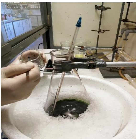
Εικόνα 4.1 Ανάμειξη του γραφίτη με το \text{NaNO}_3 και \text{H}_2\text{SO}_4
