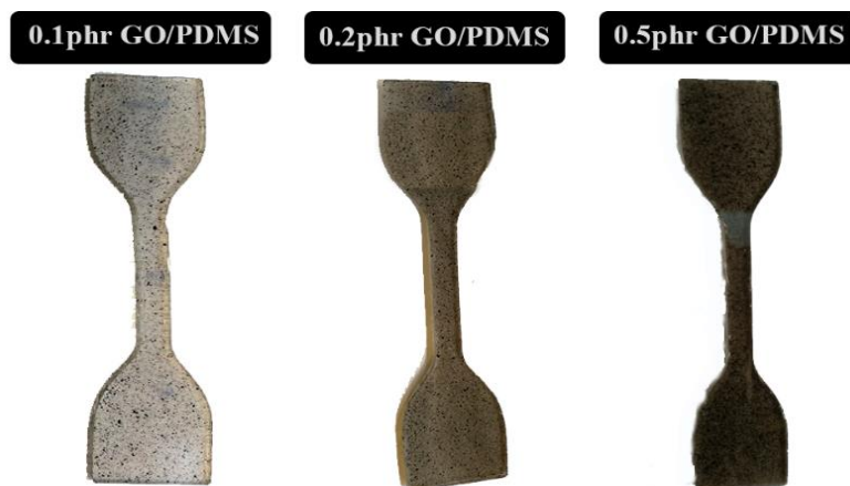
Εικόνα 4.4. Τα σύνθετα που παρασκευάστηκαν με την χρήση υπερήχων.
