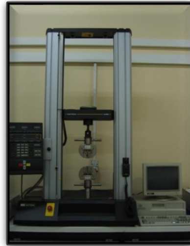
Εικόνα 4.17. Μηχάνημα κοπής δοκιμίων (αριστερά), διάταξη δοκιμής σε εφελκυσμό (δεξιά).
