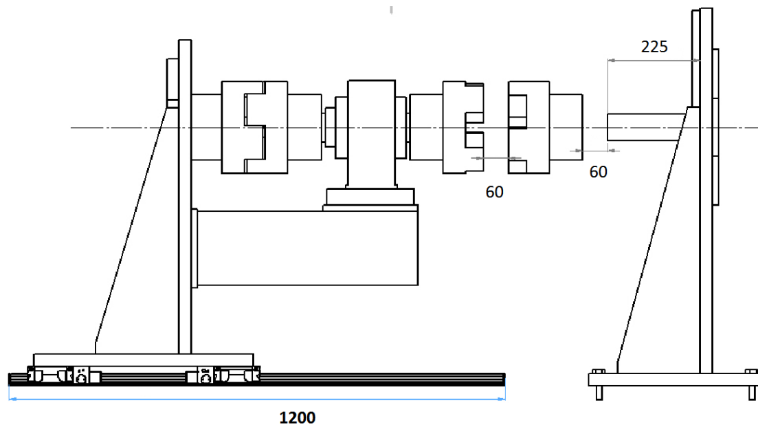
Σχήμα 3.14 Μακρύτερος άξονας δοκιμαζόμενης αντλίας και πρόβλεψη αποστάσεων για την τοποθέτηση του συνδέσμου και ελευθερία κινήσεων
