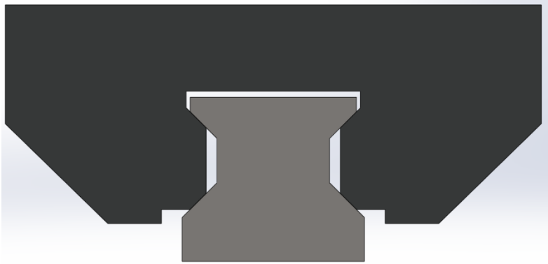
Σχήμα 4.20 Διαμόρφωση γεωμετρίας μοντέλου για τη σωστή μοντελοποίηση στο Ansys
