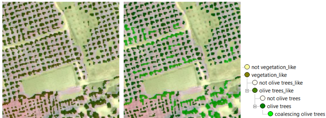
Εικόνα 40: Το αποτέλεσμα της ταξινόμησης πριν και μετά τη συγχώνευση των αντικειμένων της κατηγορίας olive tree_like της περιοχής Β
