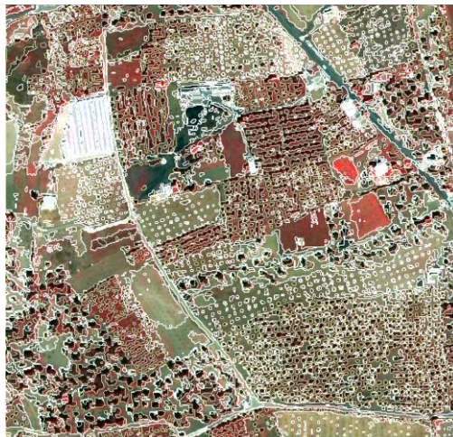
Εικόνα 48: Το αποτέλεσμα της κατάτμησης φασματικής διαφοράς με παράμετρο 5, όλων των αντικειμένων των κατηγοριών not large olive tree_like, not medium tree_like και not medium olive trees
