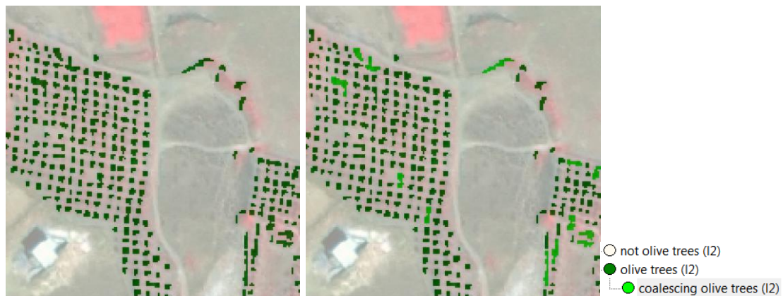
Εικόνα 29: Το αποτέλεσμα της ταξινόμησης πριν και μετά τη συγχώνευση των αντικειμένων της κατηγορίας olive trees του 2 ου επιπέδου
