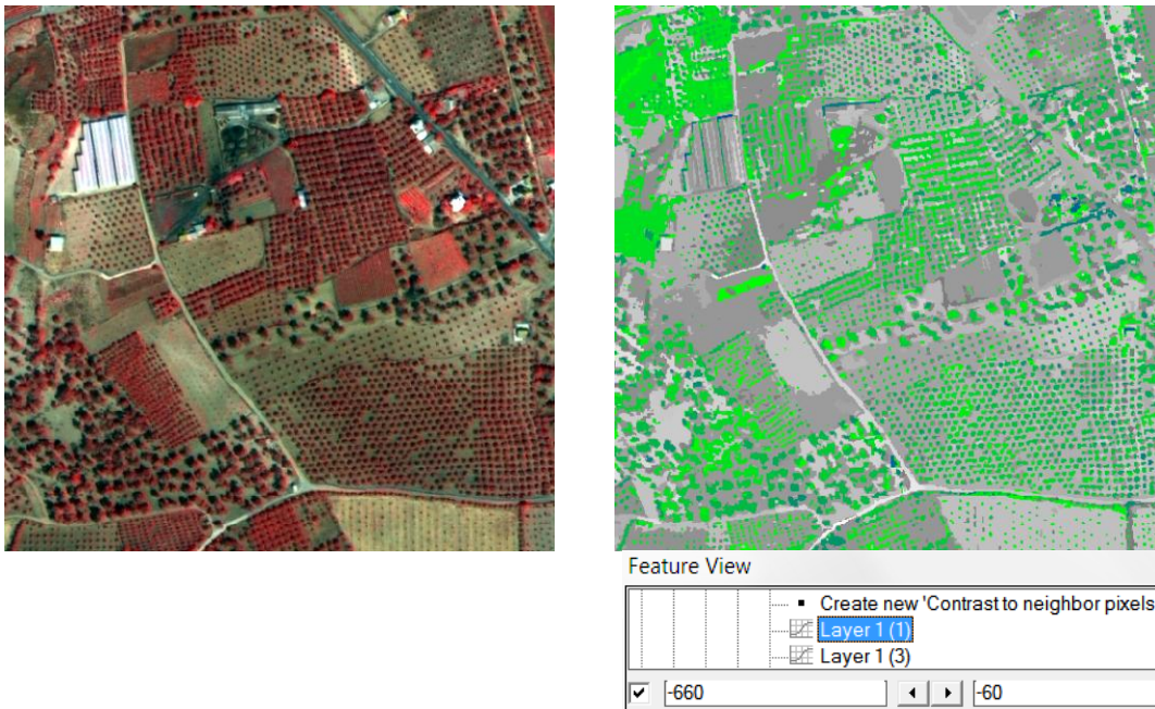
Εικόνα 49: Σύγκριση της περιοχής Κ σε έγχρωμο σύνθετο 432 με τη γραφική αναπαράσταση στο feature view του χαρακτηριστικού contrast to neighbor pixels Layer 1 (1) με τιμές από -660 έως -60
