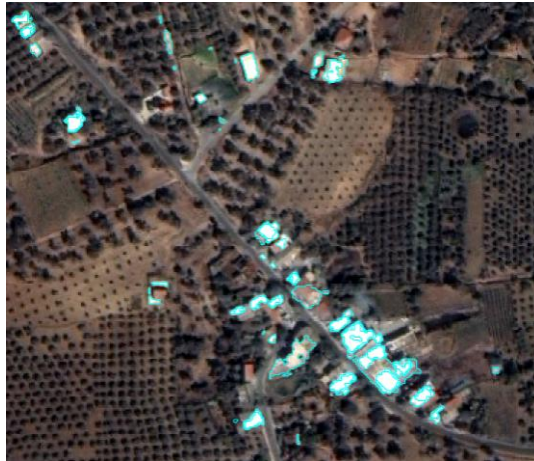
Εικόνα 6: Παράδειγμα αλγόριθμου κατάτμησης φασματικής διαφοράς
