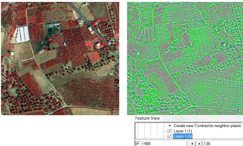
Εικόνα 46: Σύγκριση της περιοχής Κ σε έγχρωμο σύνθετο 432 με τη γραφική αναπαράσταση στο feature view του χαρακτηριστικού contrast to neighbor pixels Layer 1 (3) με τιμές από -900 έως -28
