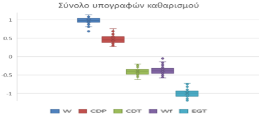
Σχήμα 4.29: Υπογραφή λόγω καθαρισμού βρομίσματος του συμπιεστή
