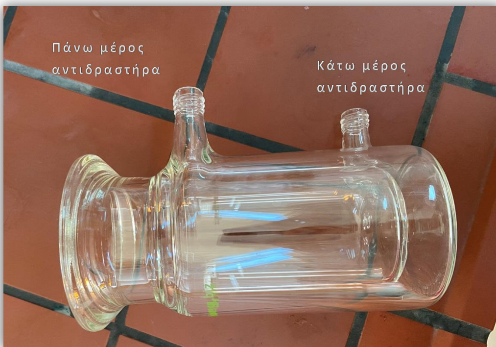
Εικόνα 1.5 Υπο δοχή και έξοδος νερού ψύξης στον αντιδραστήρα που χρησιμοποιείται κατά την ακτινοβόληση με υπερήχους 20kHz
