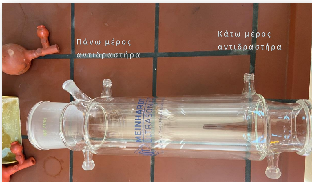
Εικόνα 1.5 Υπο δοχή και έξοδος νερού ψύξης στον αντιδραστήρα που χρησιμοποιείται κατά την ακτινοβόληση με υπερήχους 20kHz
