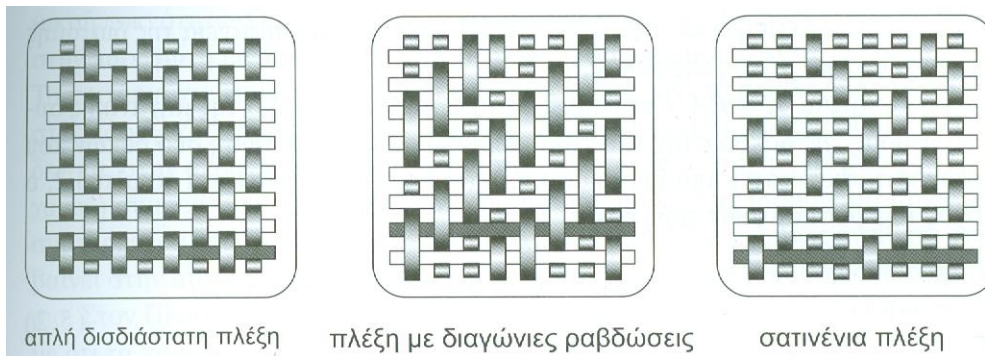
Εικόνα 3.4 [9] Σχηματική αναπαράσταση τριών δισδιάστατων πλέξεων που συναντώνται συχνά στα πλεκτά σύνθετα υλικά
