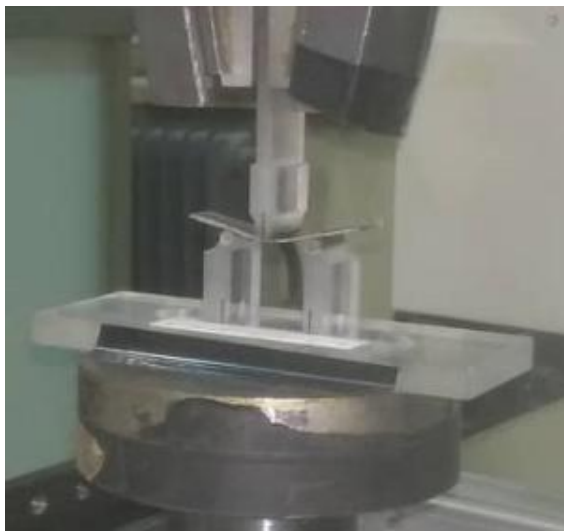
Εικόνα 5.12 αριστερά: κάμψη 3 σημείων στο εργαστήριο, δεξιά: τυπικό διάγραμμα δύναμης-μετατόπισης. Με κόκκινο συμβολίζεται το γραμμικό μέρος του διαγράμματος.
