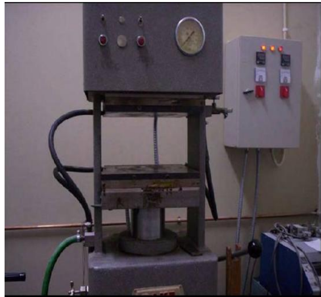
Εικόνα 5.3 Αριστερά film stacking method [40] Εναλλάξ στρώματα ινώδους ενισχυτικού και μήτρας πιέζονται απο τις θερμές πλάκες της θερμοπρέσσας. Δεξιά: Θερμοπρέσσα του εργαστηρίου
