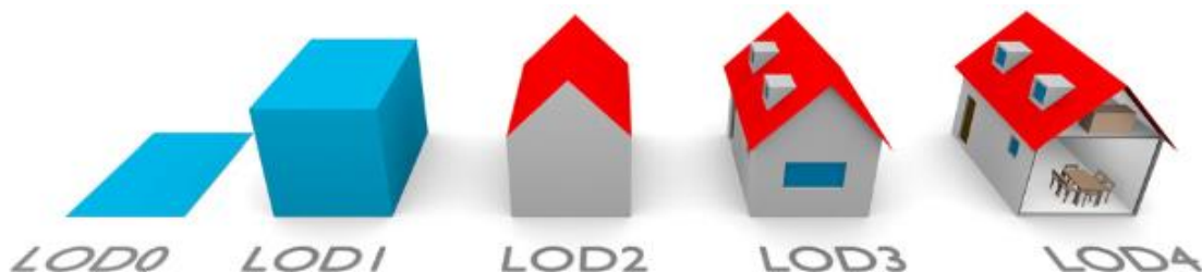
Σχήμα 4.3-5: Αναπαράσταση επιπέδων λεπτομέρειας (LoD), κατά το πρότυπο CityGML, όπου η γεωμετρική και σημασιολογική πολυπλοκότητα σταματά το LoD 4 που περιγράφει μέχρι και στοιχεία εσωτερικού χώρου. (Biljecki, F. et al., 2016)
