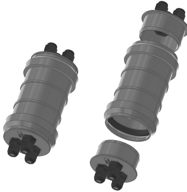
Εικόνα 3.23 - Σύνδεσμος σωλήνων πολυπροπυλενίου, με πώματα επί των οποίων στερεώνονται στυπιοθλίπτες, σε κλειστή [αριστερά] και ανοικτή θέση [δεξιά]. Λειτουργεί ως περίβλημα για τα USB repeaters που παρεμβάλλονται στη διασύνδεση συστήματος-χρήστη. Η στεγανότητα στα πώματα εξασφαλίζεται με την περιεχόμενη τσιμούχα (διακρίνεται με μαύρο χρώμα στο κάτω χείλος).
