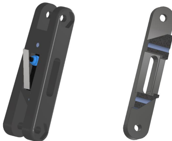
Εικόνα 3.16 - Ο εξωτερικός σύνδεσμος των δακτύλων, στον οποίο ενσωματώνεται ο διακόπτης. Σε τομή [δεξιά] φαίνεται η βάση του διακόπτη.
