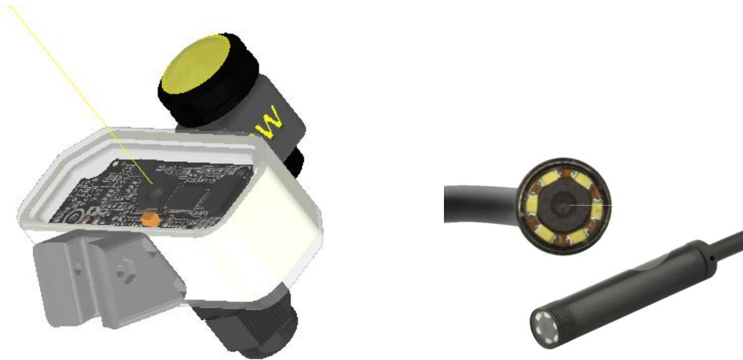
Εικόνα 2.17 - Webcam Creative Live!Cam [αριστερά]. Φαίνεται το PCB με τον αισθητήρα & το φακό, μέσα στο περίβλημα από PVC και τα δύο διαφανή καπάκια από ακρυλικό πλαστικό. Στην παράπλευρη επιφάνεια φαίνεται η βάση για το περίβλημα του στοιχείου δράσης και η επιπλέον λυχνία LED, στο πίσω μέρος. Στο κάτω μέρος διακρίνεται με μαύρο χρώμα ο στυπιοθλίπτης. Ενδοσκοπική κάμερα μικρών διαστάσεων IP68, 720p (7mm διάμετρος, 50mm μήκος) [δεξιά].
