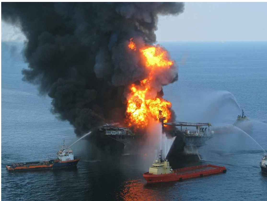
Σχήμα 16: Blowout ακολουθούμενο από ανάφλεξη. Deepwater Horizon, κόλπος του Μεξικό, 2010.
