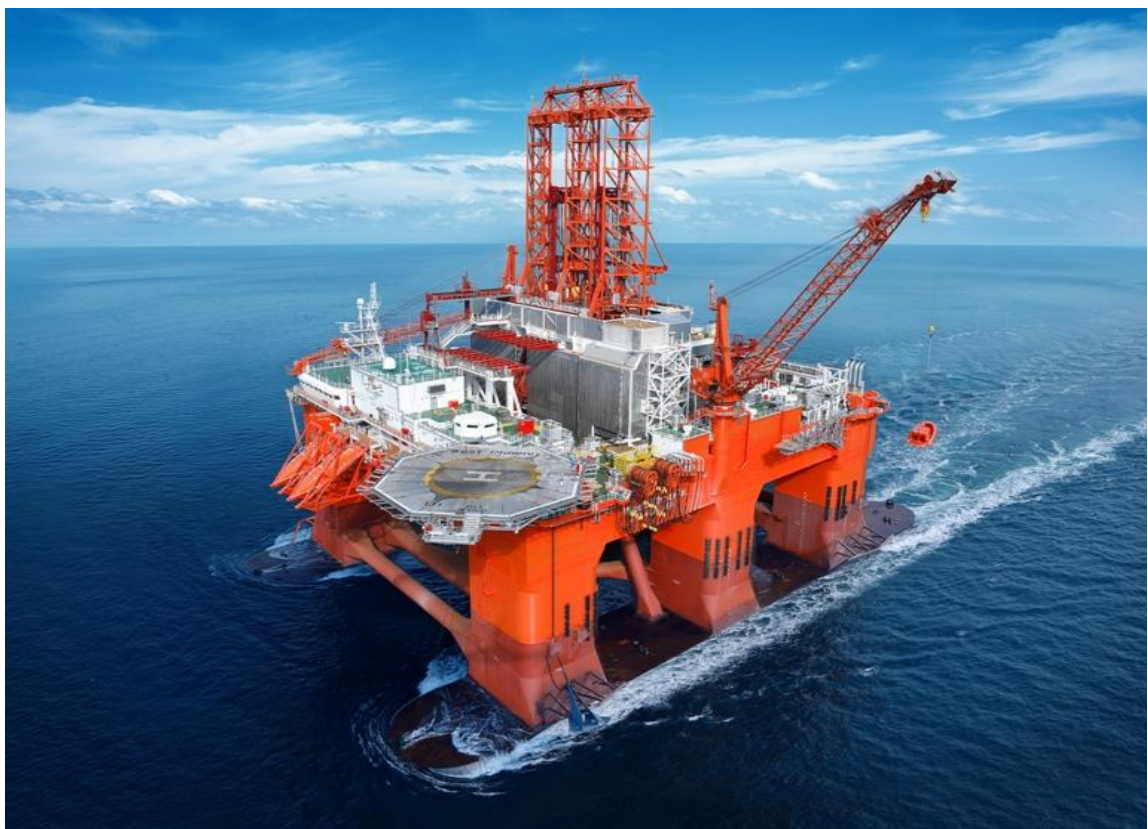
Σχήμα 10: Αυτοπροωθούμενη ημιβυθιζόμενη πλατφόρμα [43].
