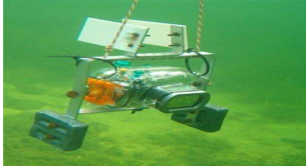
Σχήμα 25: Η χρήση ρυμουλκούμενης βιντεοκάμερας συνίσταται για ιχνηλασιμότητα θαλάσσιων απορριμμάτων που βρίσκονται σε ρηχά επιφανειακά ύδατα (Lazo)
