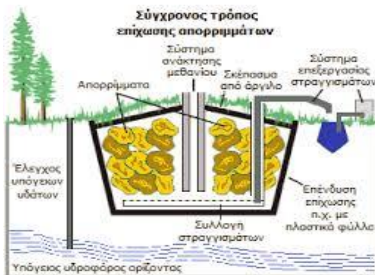
Σχήμα 9: Τρόπος λειτουργίας ενός ΧΥΤΑ (ΕΛΛΗΝΙΚΗ ΕΤΑΙΡΕΙΑ ΔΙΑΧΕΙΡΙΣΗΣ ΣΤΕΡΕΩΝ ΑΠΟΒΛΗΤΩΝ)
