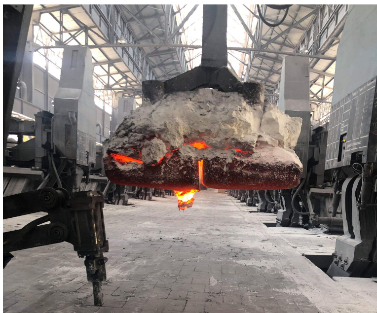
Σχήμα 1.2: Μανιτάρι που προεξέρχει από τον πυθμένα ανόδου, η οποία έχει απομακρυνθεί από το εσωτερικό της λεκάνης στο πλαίσιο εργασιών στη λεκάνη.
