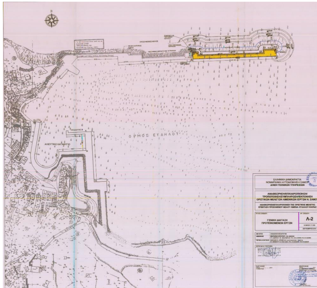
Σχήμα 28: Κάτοψη λιμένα με την προέκταση (Πηγή: Φράγκου, 2010)
