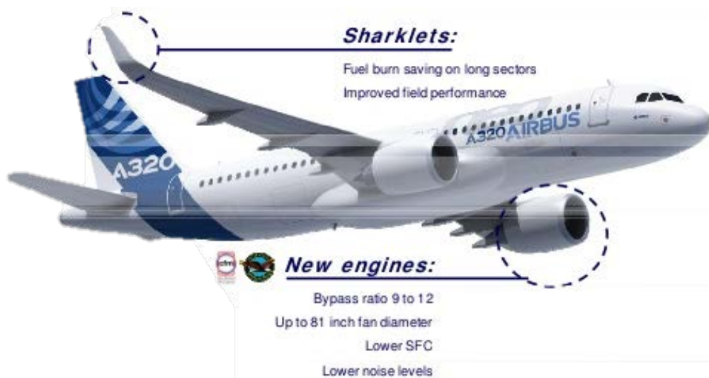
Εικόνα 3.1: A320neo Program - Σημαντικές τροποποιήσεις
