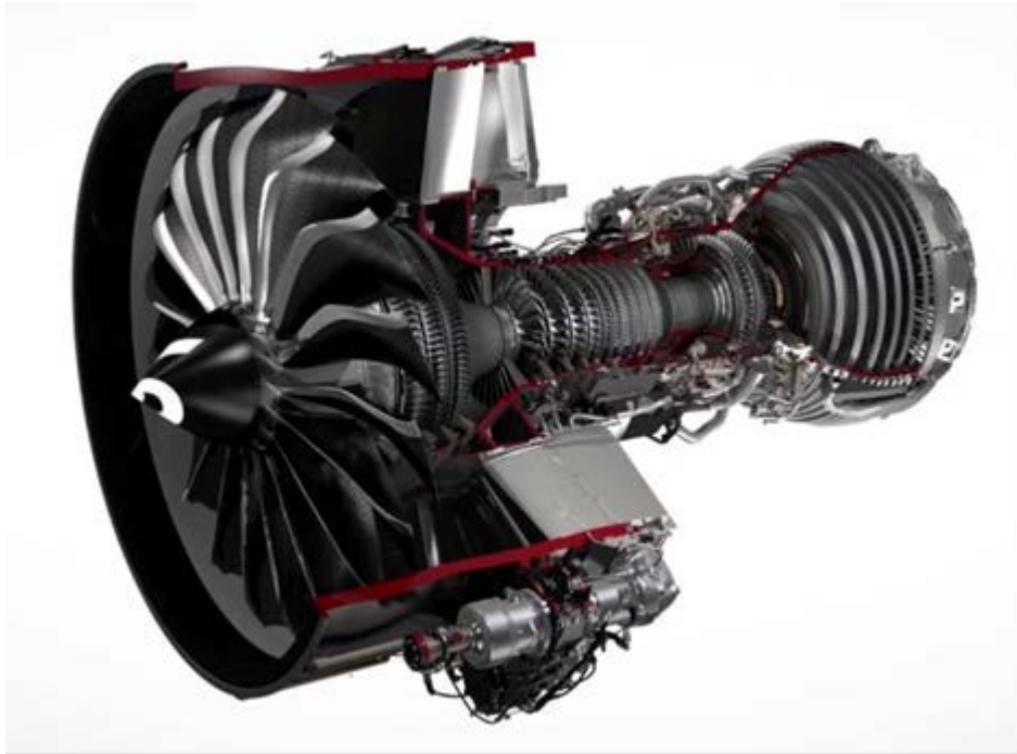
Εικόνα 4.1 Ημιτομή κινητήρα CFM LEAP -1A
