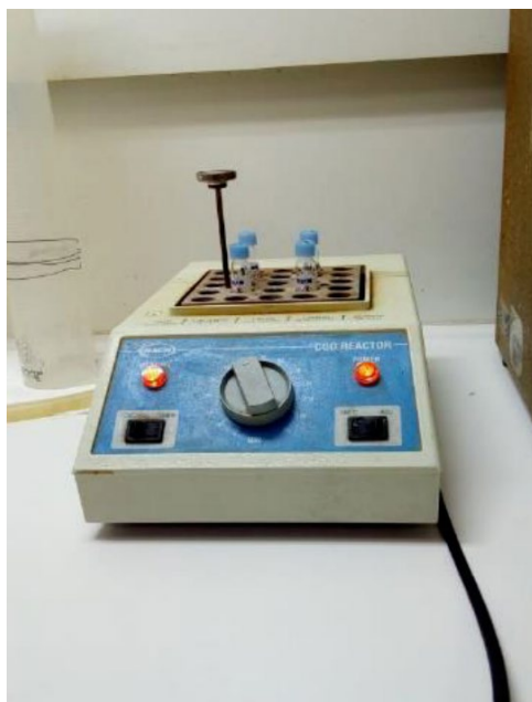
Εικόνα 3.8: Συσκευή χώνευσης (Πηγή: Προσωπικό υλικό)
