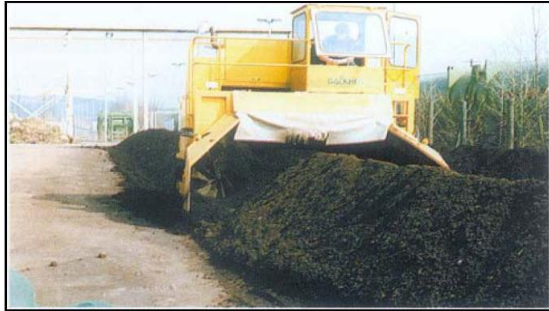
Εικόνα 2. 1 Σύστημα αναστρεφόμενων σειραδίων με χρήση αυτοκινούμενου αναστροφέα [26]
