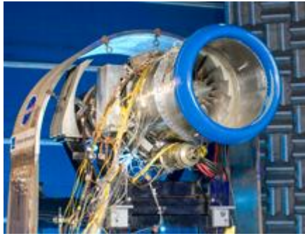
Εικόνα 2.14. Μεταλλικός αφρός μειώνει τον ήχο της τουρμπίνας αεροσκάφους
