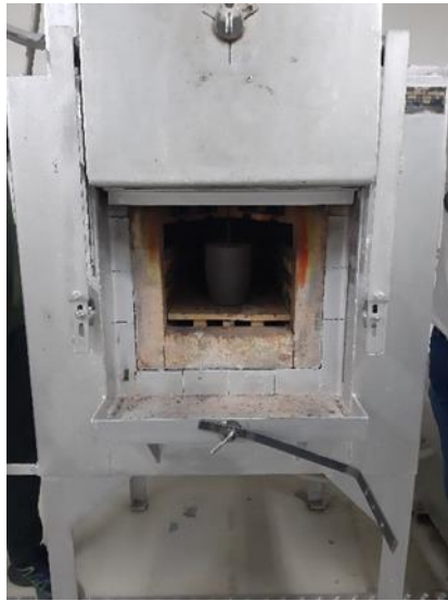
Εικόνα 4.2. Κλίβανος χύτευσης με καλούπι.
