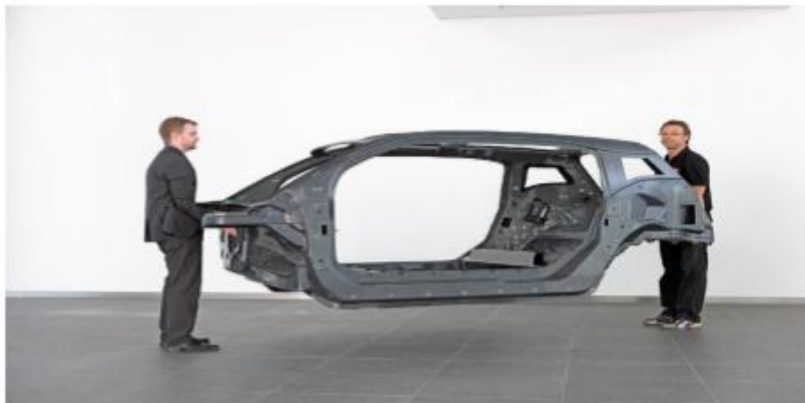
Εικόνα 1.13. Σκελετός αυτοκινήτου τύπου BMW i3 με ίνες άνθρακα.
