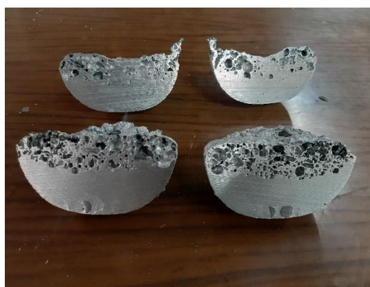
Εικόνα 4.12. Αφροί αλουμινίου με μη ομοιόμορφα κατανομημένο πορώδες.
