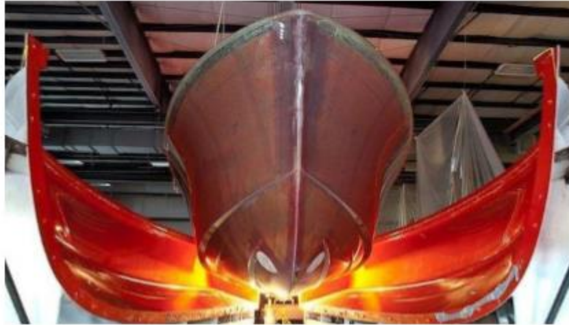
Εικόνα 1.14. Χύτευση σε καλούπι για κατασκευή σκάφους.
