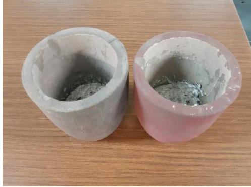
Εικόνα 4.5. Καλούπια χύτευσης με αφρό αλουμινίου.
