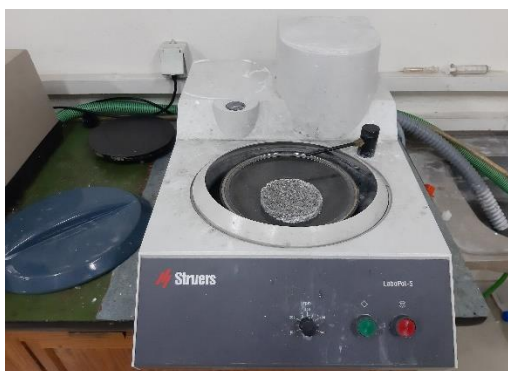
Εικόνα 4.10. Τεμαχισμένη φέτα αφρού αλουμινίου, στον τροχό λείανσης.
