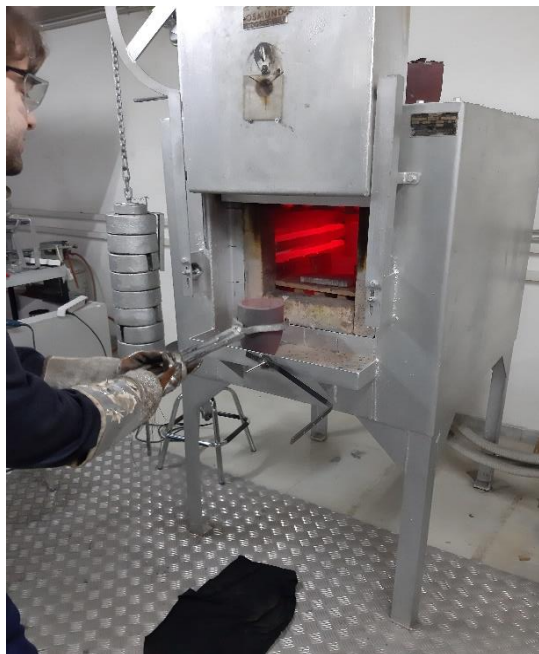
Εικόνα 4.3. Τεχνίτης βγάζει το καλούπι από τον κλίβανο Εικόνα 4.4. Απαραίτητη ανάδευση
