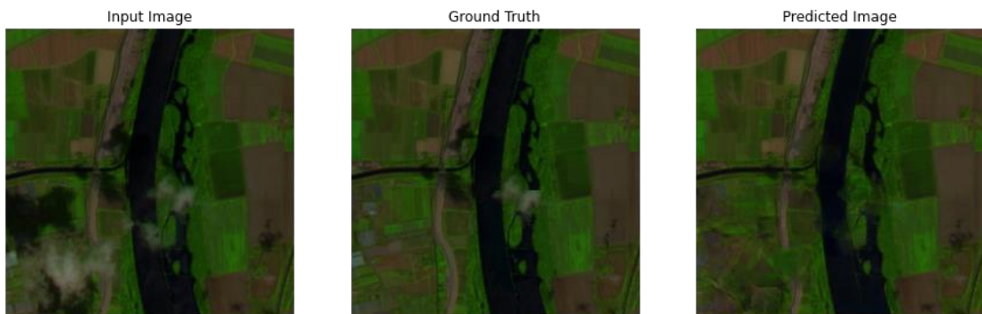
Εικόνα 5-3: 3 ο παράδειγμα επιτυχημένου αποτελέσματος μοντέλου rix2pix.
