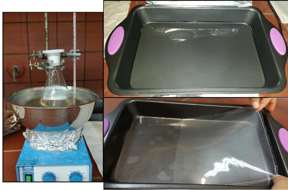
Εικόνα 13: Κατασκευή φύλλων PLA με την τεχνική χύτευσης με διαλύτη.
