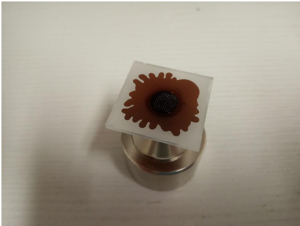
Σχήμα 3-27. Υπερυδρόφοβη επιφάνεια σε υλικό PMMA, με κατεργασία πλάσματος οξυγόνου και C_4F_8 . Πάνω στην επιφάνεια έχει τοποθετηθεί σιδηρομαγνητικό ρευστό, ενώ από την άλλη πλευρά της βρίσκεται ο μαγνήτης.
