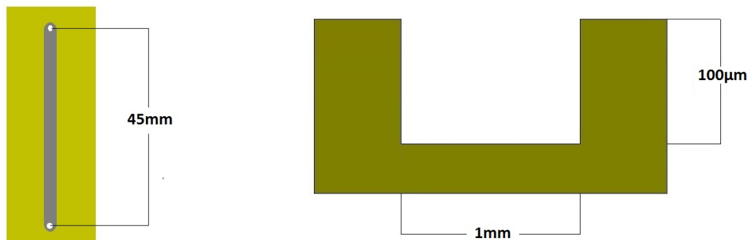
Εικόνα 4.13. Σχηματικό διάγραμμα του μικροροϊκού καναλιού, όπου φαίνονται οι διαστάσεις του ( L \times w \times h = 45\text{mm} \times 1\text{mm} \times 100\mu\text{m} ).
