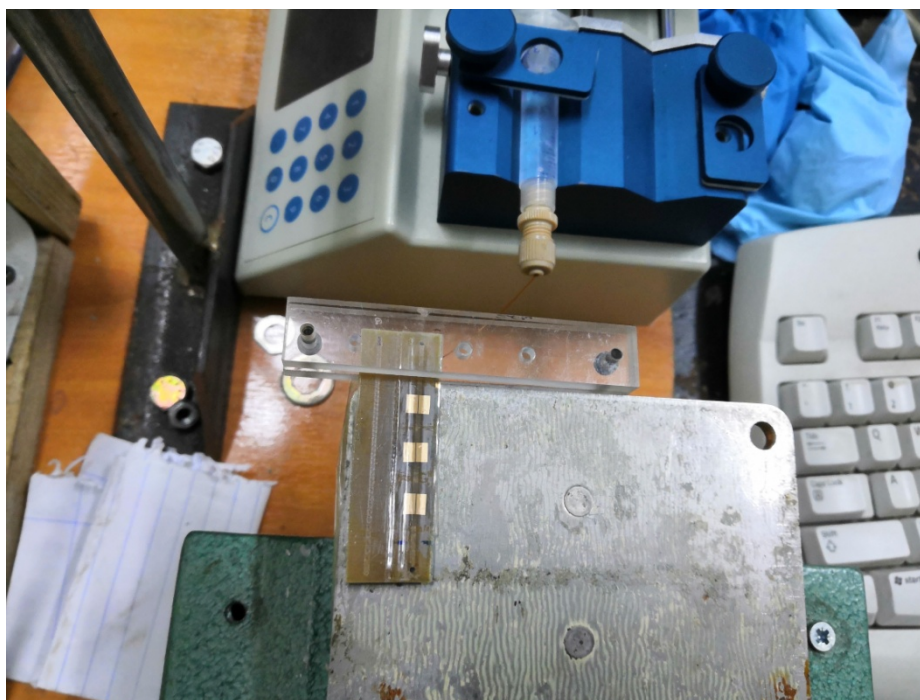
Εικόνα 4.15. Η συνολική διάταξη αισθητήρων-βάσης-αντλίας κατά τη μέτρηση.
